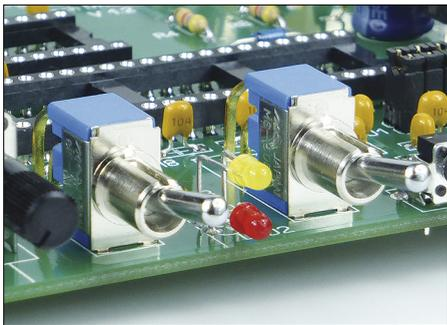
**Bild 4: Richtige Einbaulage der beiden Leuchtdioden LED1 und LED2**
