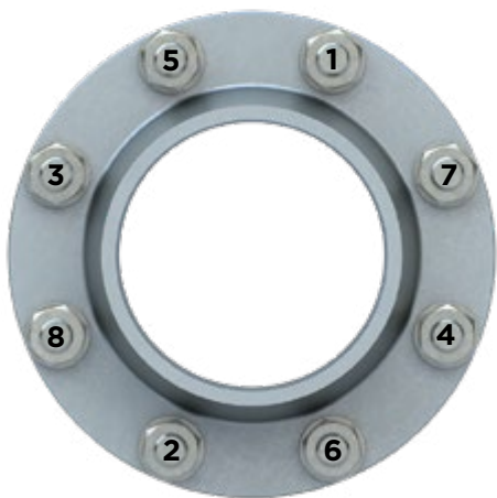
Abbildung 2 - Anzugsmuster der Flanschschrauben
