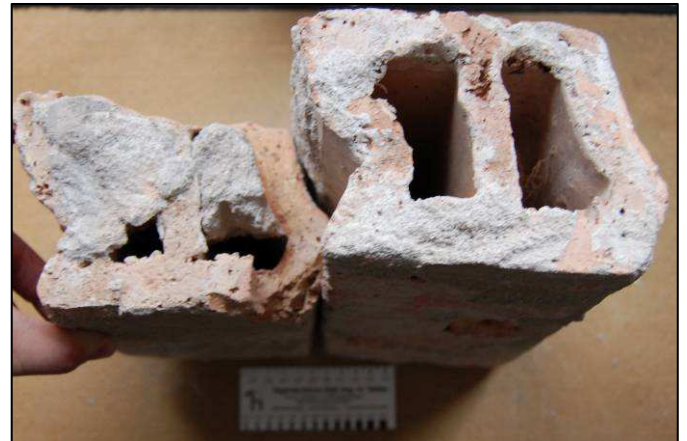
Bild 21: Ansicht Systemstein der Försterdecke
