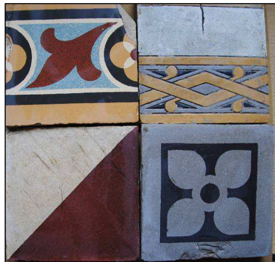
Bild 9: Dekorfliesen des Herstellers Villeroy u. Boch aus dem abgerissenen alten Aachener Klinikum (Fertigstellung 1914)
