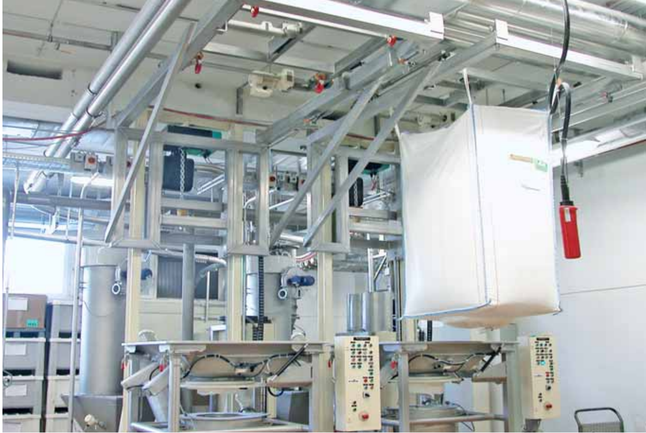
11 Big Bag Entleerstation mit verfahrbarem Tragrahmen
