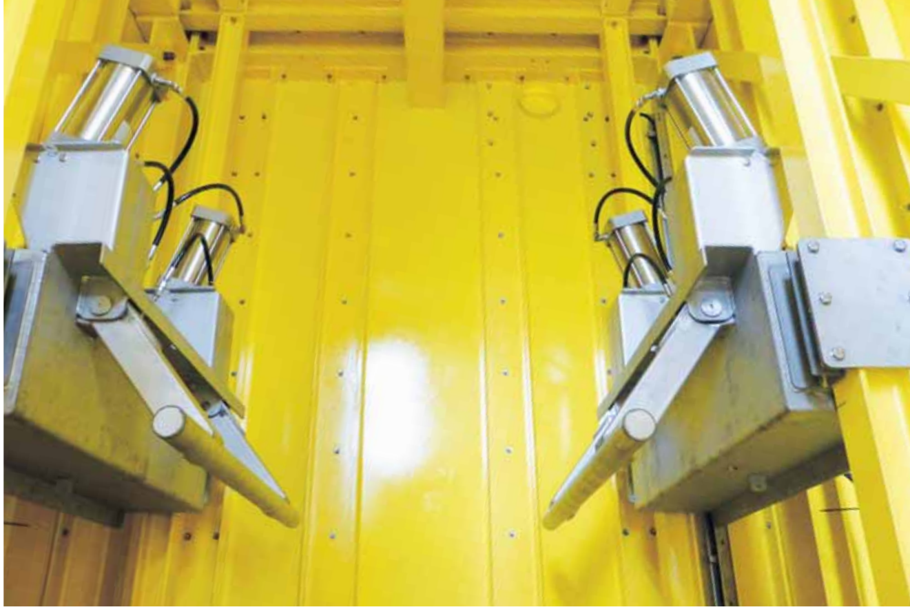
38 Seitenwalkvorrichtung in Big Bag Entleeranlage
