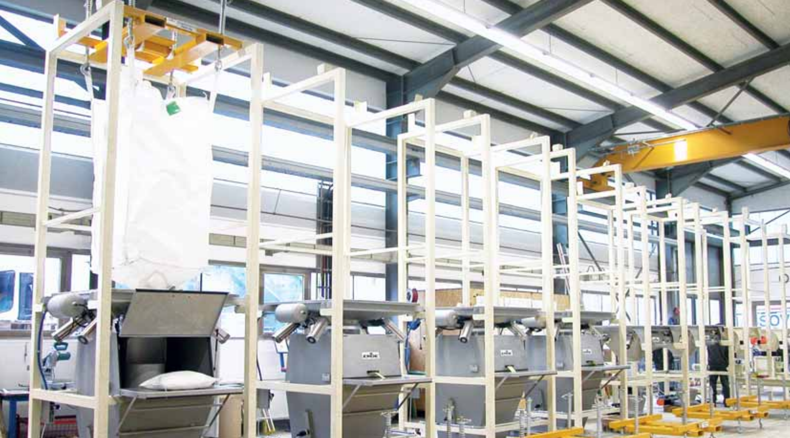
8 Kombinierte Sack-/Big Bag-Entleerstation in Endmontage
