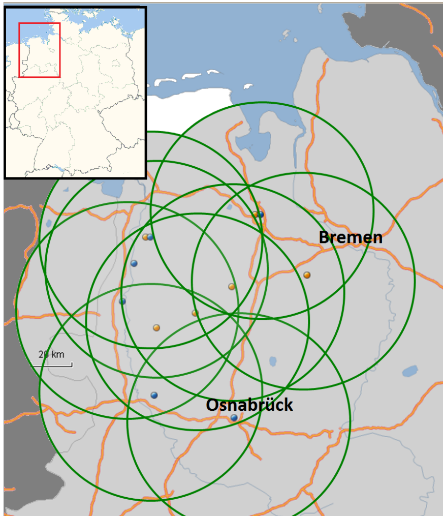
Abbildung 17: Mögliche Transportentfernung bei einer Dieselpreissteigerung um 100 % (von heute 0,037 €/tkm auf 0,112 €/tkm) und einer Kostensteigerung um 100 % (variable und fixe Kosten) in der Region Nord-West. (Stepmaps, 2013; BM-V, 2013)
