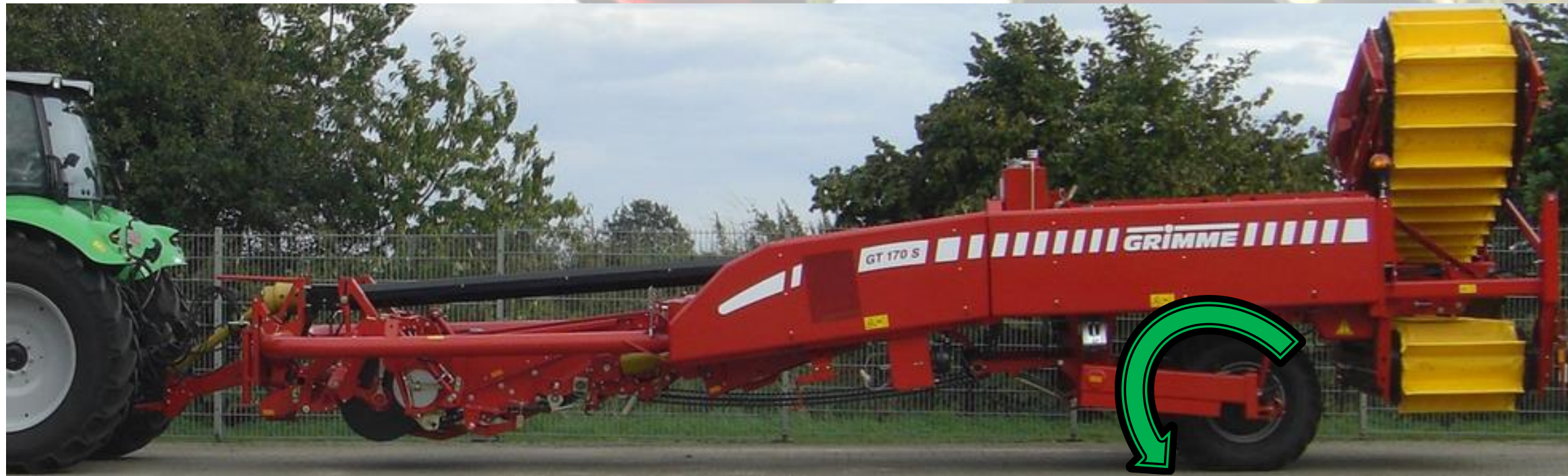
GT 170 mit hydrostatischen Radantrieb
