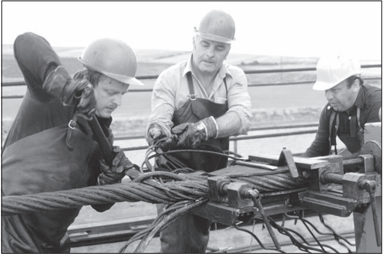
Bild 34: Spleißer bei der Arbeit
