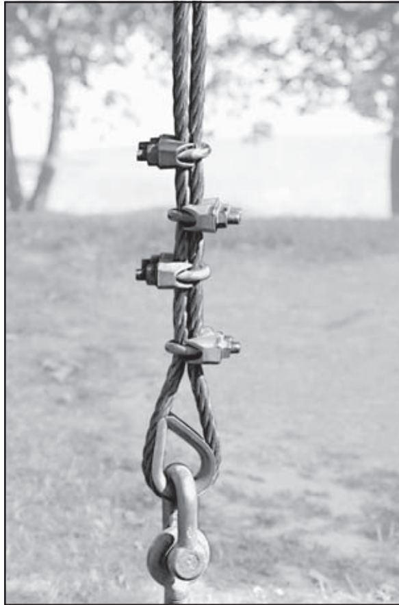
Bild 8: Unsachgemäß ausgeführte Seilendverbindung mit Drahtseilklemmen
