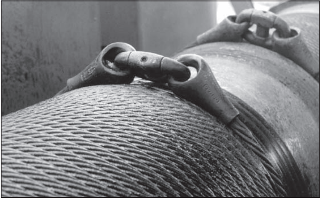
Bild 77: Schnabelrollenbirnen mit Kupplung auf einer Seiltrommel
