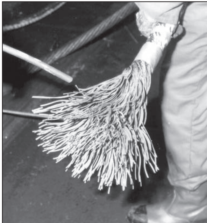
Bild 69: Abblasen des Seilbesens
