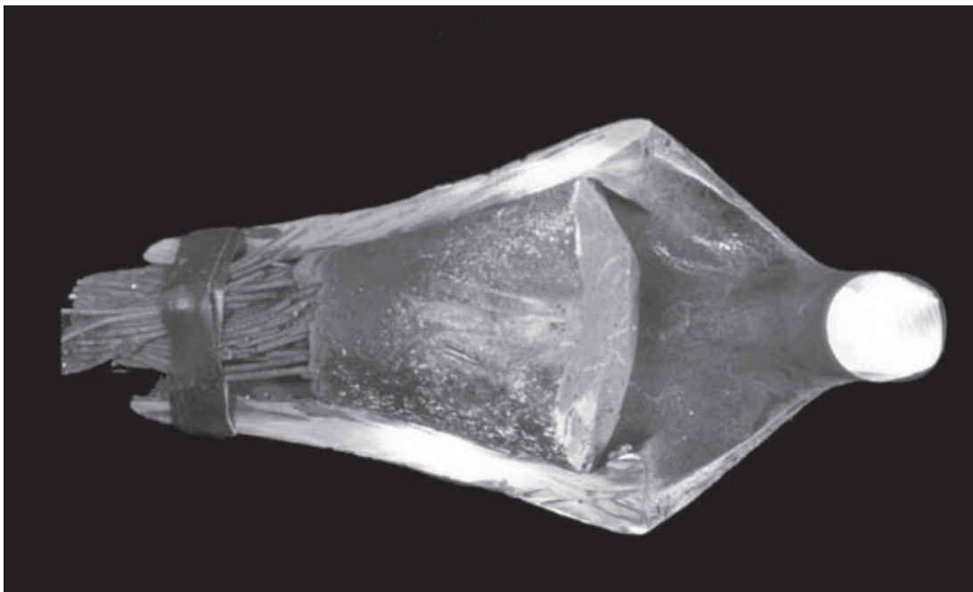
Bild 78: Schnitt durch eine Schnabelrollenbirne mit Seilschaden
