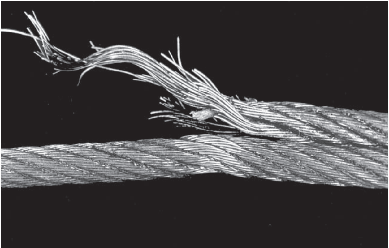
Bild 17: Seilbruch an der Klemmstelle
