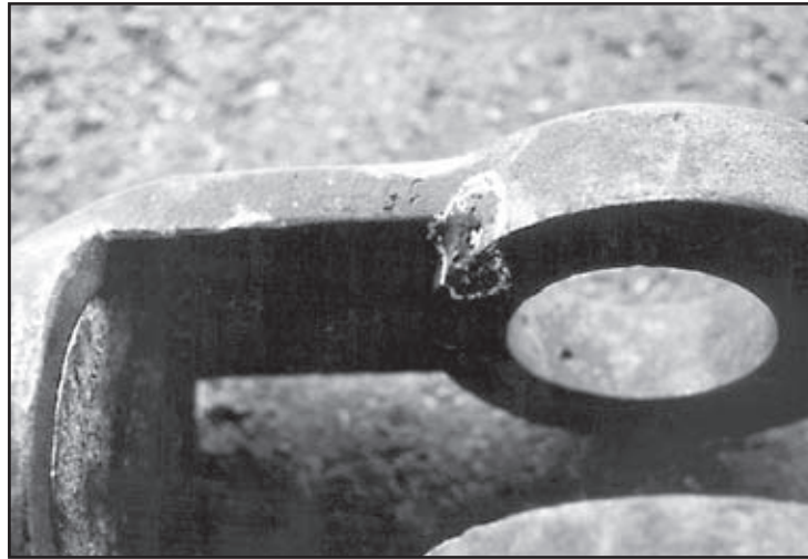
Bild 67: Gußfehler an einer Gabelseilhülse
