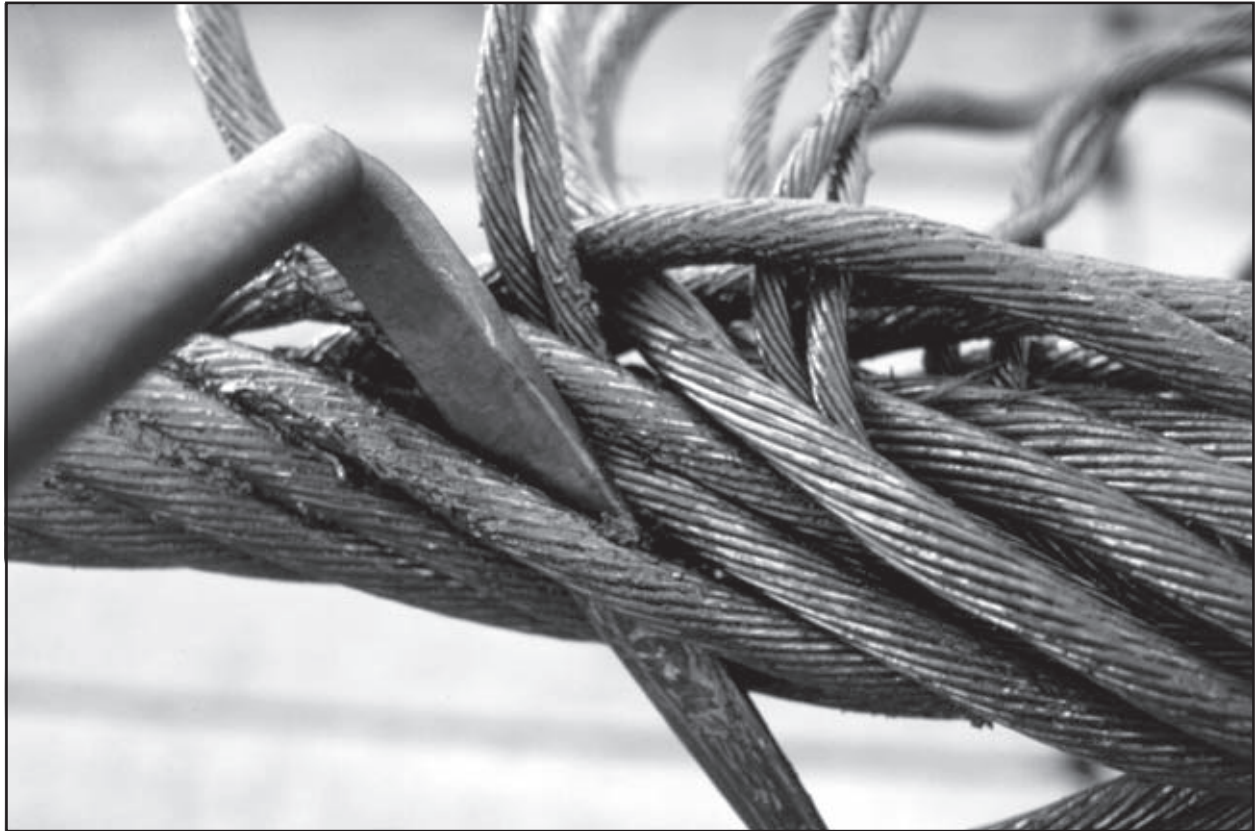
Bild 33: Spleiß an einem achtlitzigen Drahtseil mit Stahleinlage
