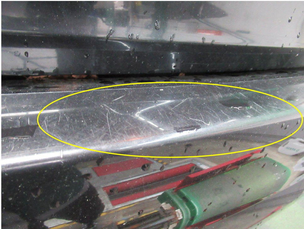
Bild 15 : Stoßfänger hinten Lackierung, zerkratzt, lackieren
