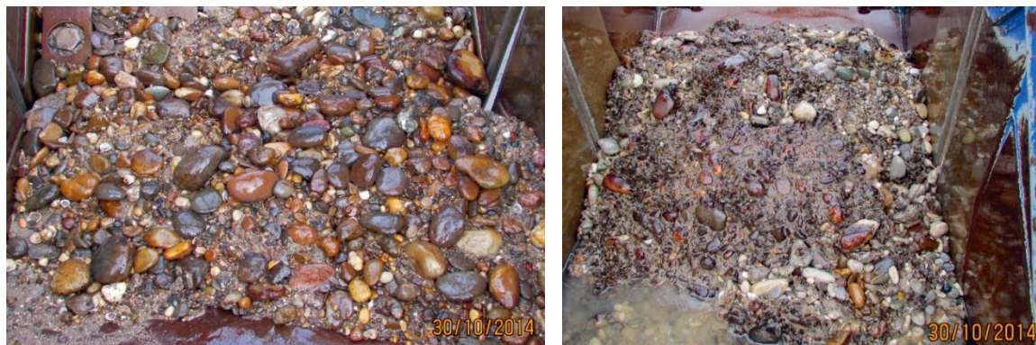
Abb. 5.7: Greiferproben der Rheinsohle aus der Stauhaltung Iffezheim (links: km 315,8, rechts: km 317,7 jeweils ca. 40 m vom linken Ufer) (Foto: Hillebrand, 2014).
