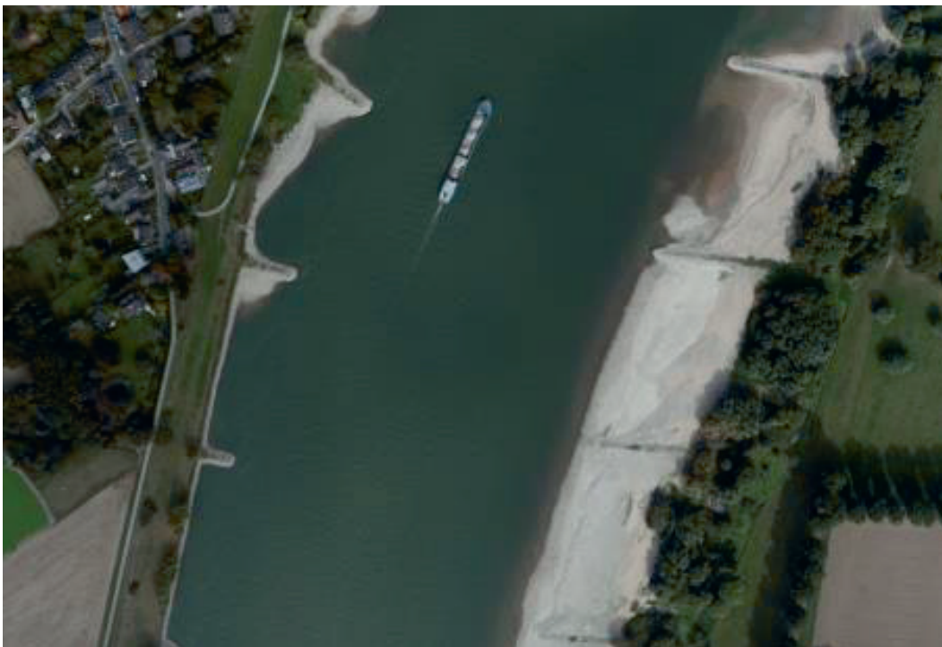
Abb. 8.7: Beispiel einer verlandeten Bühnenfeldgruppe bei Uedesheim (zwischen Rhein-km 728 und 729), Aufnahme während einer Niedrigwasserbefliegung am 19.09.2009.
