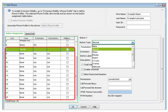
Schritt 8: Wählen Sie **Normal** aus der Dropdown-Liste *Button Type (Schaltflächentyp)* aus, um eine normale Durchwahl auf der Telefonzentrale SPA500S zu konfigurieren.
