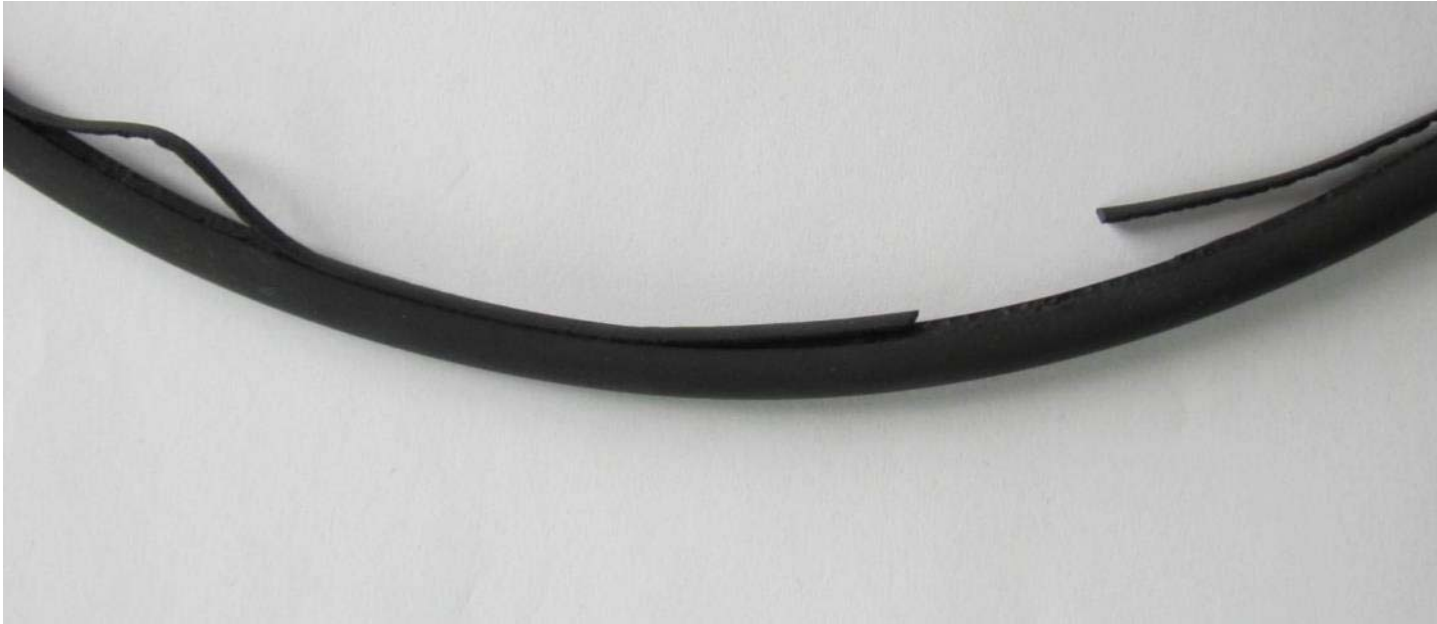
Schaden am O-Ring durch scharfkantige Bauteile.
