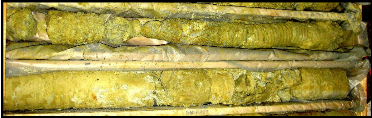
Abb. 5) Kalkstein, Mergel, Ton: Horizontale Seilkernbohrung CSK 146 mit PCD 20 x 8. Innenrohr drehte durch Verklebung zeitweise mit. Plastischer Kern verlор an Durchmesser.
