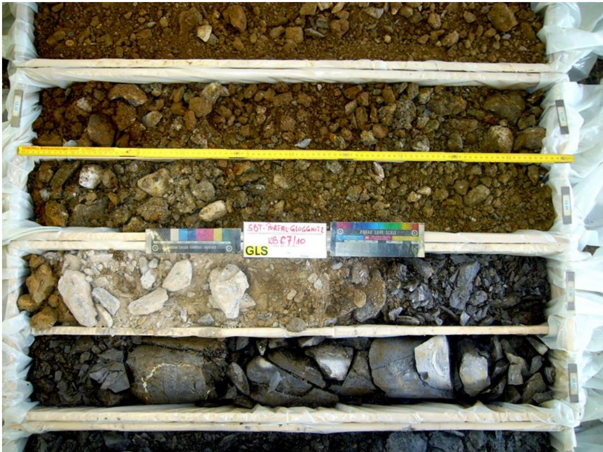
Abb. 2) Kernprobe im Übergang von Auflockerung zu kompakten Fels. Bohrverfahren wurde von „Trocken“ auf „Naß“ umgestellt bei den hellen Proben. Die Drehschlagenergie führt zur Gesteinsmehlbildung und zur Erhitzung.
