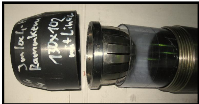
Abb. 15) Schneidschuh, Fangfeder, Liner, Kernrohr.
