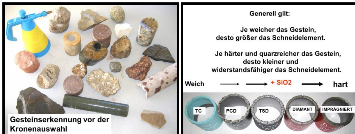
Abb. 9) Orientierungstafel für den Kroneneinsatz in Abstimmung auf die zu erbohrenden Gesteine.
