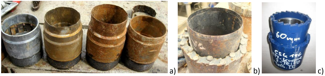
Abb. 10) Seilkernrohr CSK 146: Kronen und Kernfanghülsen für weiche, schluffig-sandige Formationen. Meth. II / IV
