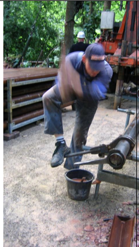
Entschrauben der Kernfanghülse des Seilkernrohres GEOBOR S.
