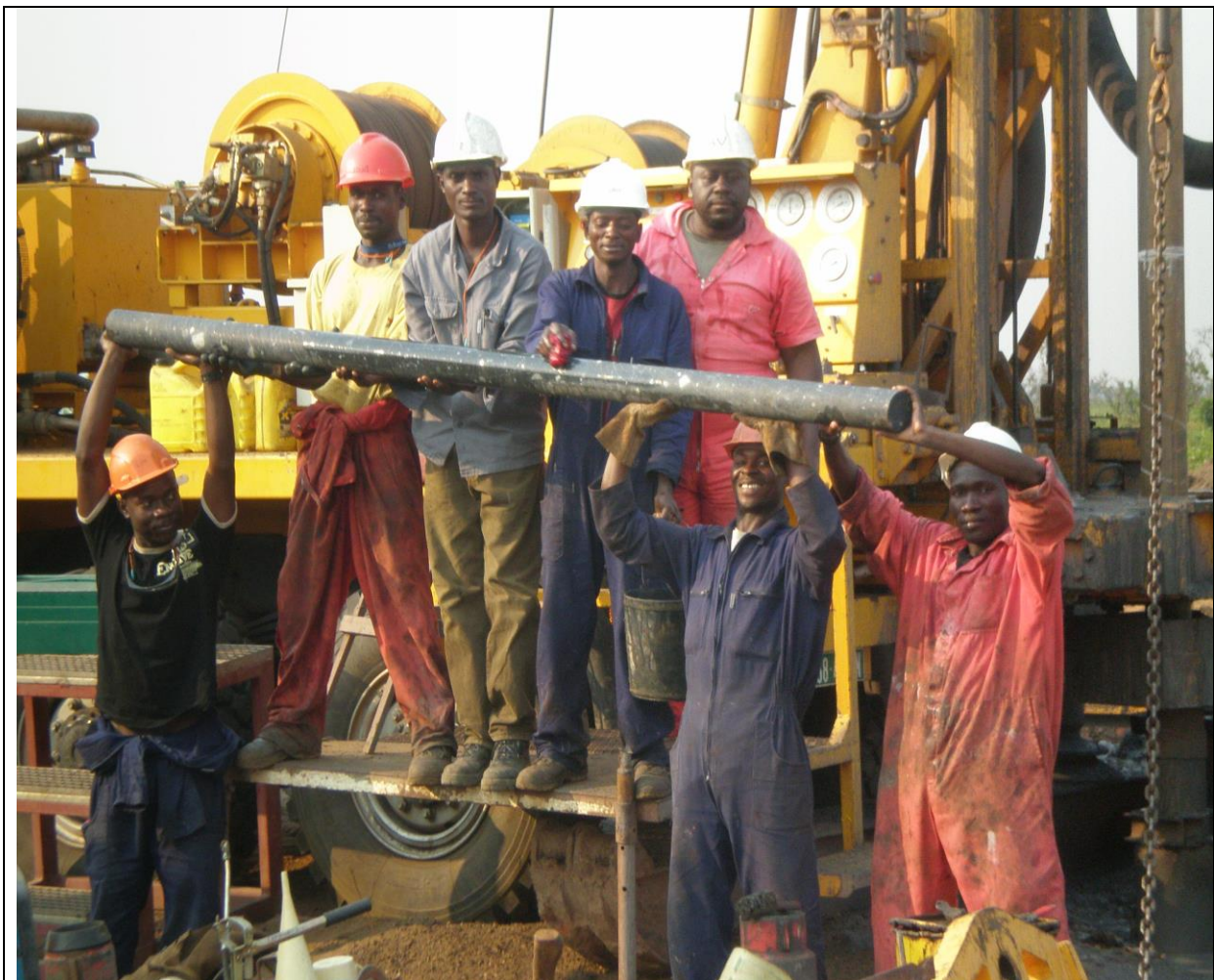
Kimberlit-Bohrkern erhobt mit dem Seilkernrohr GEOR S 156 x 102 auf einer PRAKLA-Bohranlage RB 50 in Lucapa/Angola
