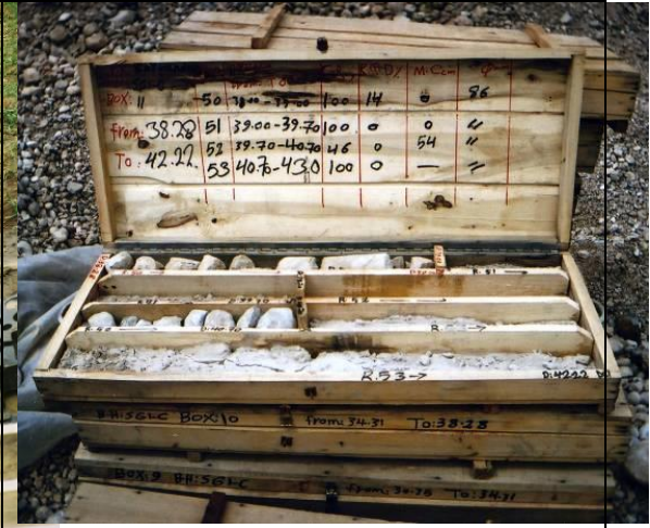
Kernverlust und Zerstörung durch ungeeignetes Bohrverfahren. Spindelbohrgerät mit Einfachkernrohr am Gotvand-Damm (Iran).
