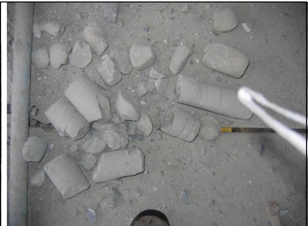
Bohrkern als Abfall. Deutlich erkennbar ist das mitrotierte ,feste Material an der unregelmäßigen Oberfläche.
