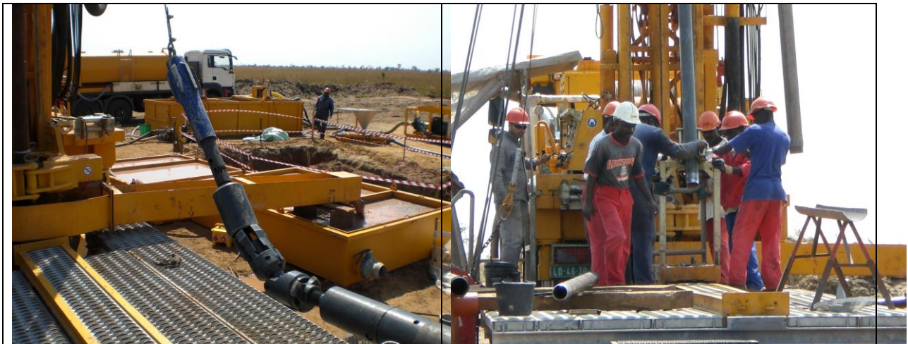
Innenrohr des CSK 156 x 102 am Fänger (Overshot) mit Kernseil.
