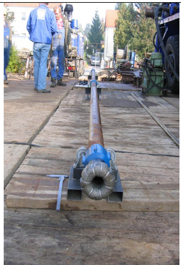
Sonderseilkernrohr 146 x 47,5 mm mit Naturdiamant-Bohrkrone.
