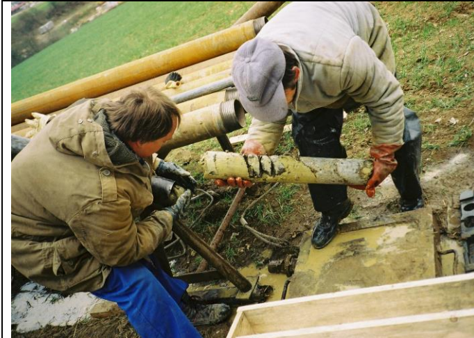
Harter Muschelkalk und weiche Klufflehme bei bestem Zusammenspiel von Kernrohr, Krone und Geräteführer. Seilkernrohr SK6L 146 x 102 bei Würzburg.
