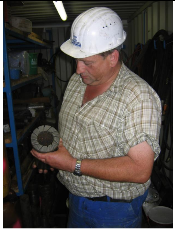
Bohrmeister mit Diamantimprägnierter Kernbohrkrone für quarzitischen Sandstein der Rotliegend-Formation bei Ibbenbüren.
