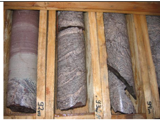
Eine diamantimprägnierte Bohrkronerbohrte diese Kerne. Rotliegend-Sandstein auf Gneis des Grundgebirges (Nordschwarzwald).
