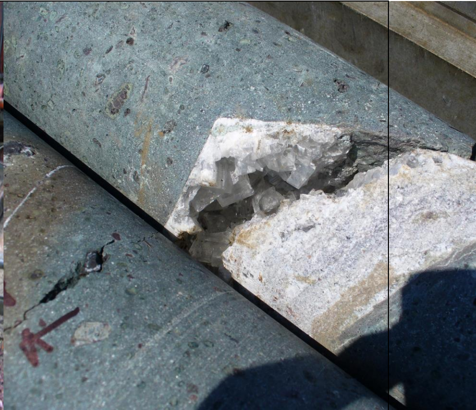
Bohrkern 102 mm aus dem „Blue Ground“ des Diamanthaltigen Kimberlits. Gebohrt mit Geobor S und CSK 156 x 102 auf einer PRAKLA Bohranlage RB 50 in Lucapa/Angola.
