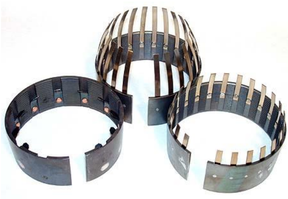
Kernfangringe von links: kurze breite Federn, Lange schmale Federn, kurze schmale Federn
