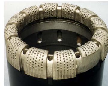
Oberflächengesetzte Diamantbohrkrone BN-Form mit 12 Spülungswegen, 12 Spülungsbohrungen u. Junkslots
