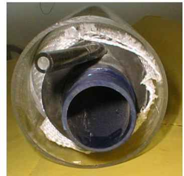
Filtergewebeslauch NW 100 auf PVC-Rohr mit seitlicher Injektionsleitung Abdichtung mit Moosgummi
