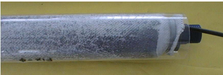
Filtergewebeslauch NW 100 auf PVC-Rohr mit seitlicher Injektionsleitung Abdichtung mit Moosgummi
