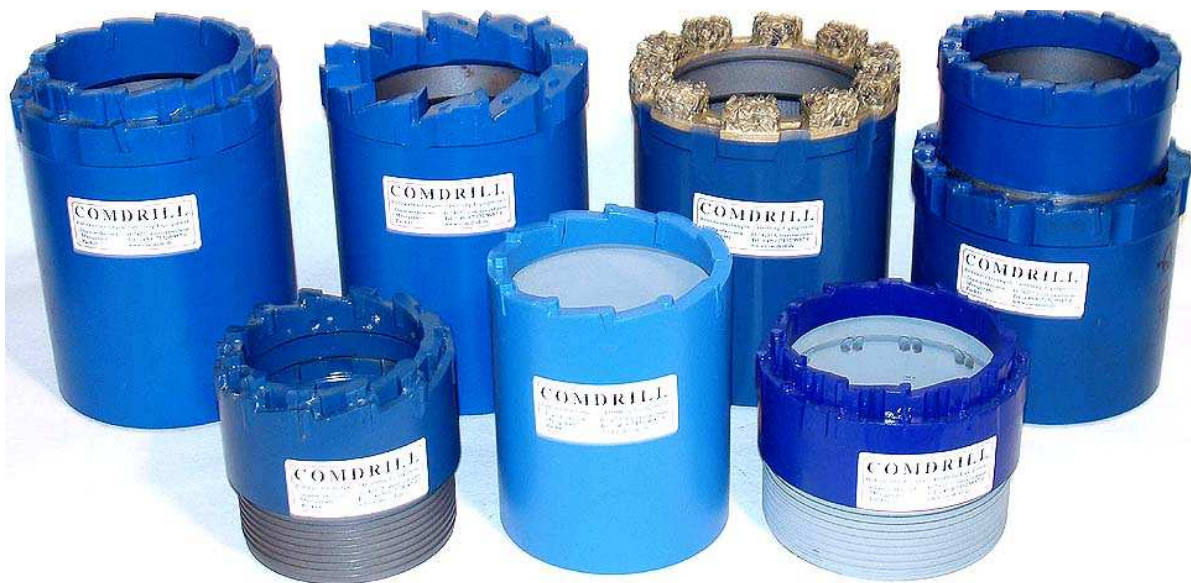
vordere Reihe v. links: Stufenkrone mit großen Spülungsbohrungen durch die Lippe, Standardkrone, Stufenkrone mit kleinen Spülungsbohrungen durch die Lippe hintere Reihe v. links: Pilotbohrkrone 15 mm, HM-Platten Bohrkrone (Meth. I), Corborit-Bohrkrone, Pilotbohrkrone zweiteilig mit 60 mm Pilot (Methode II)
