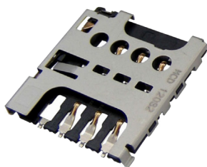
micro-SIM Kartenhalterung, Push-Pull-Design, 1,40mm hoch, mit Erkennungsfeature (Serie 78727)
