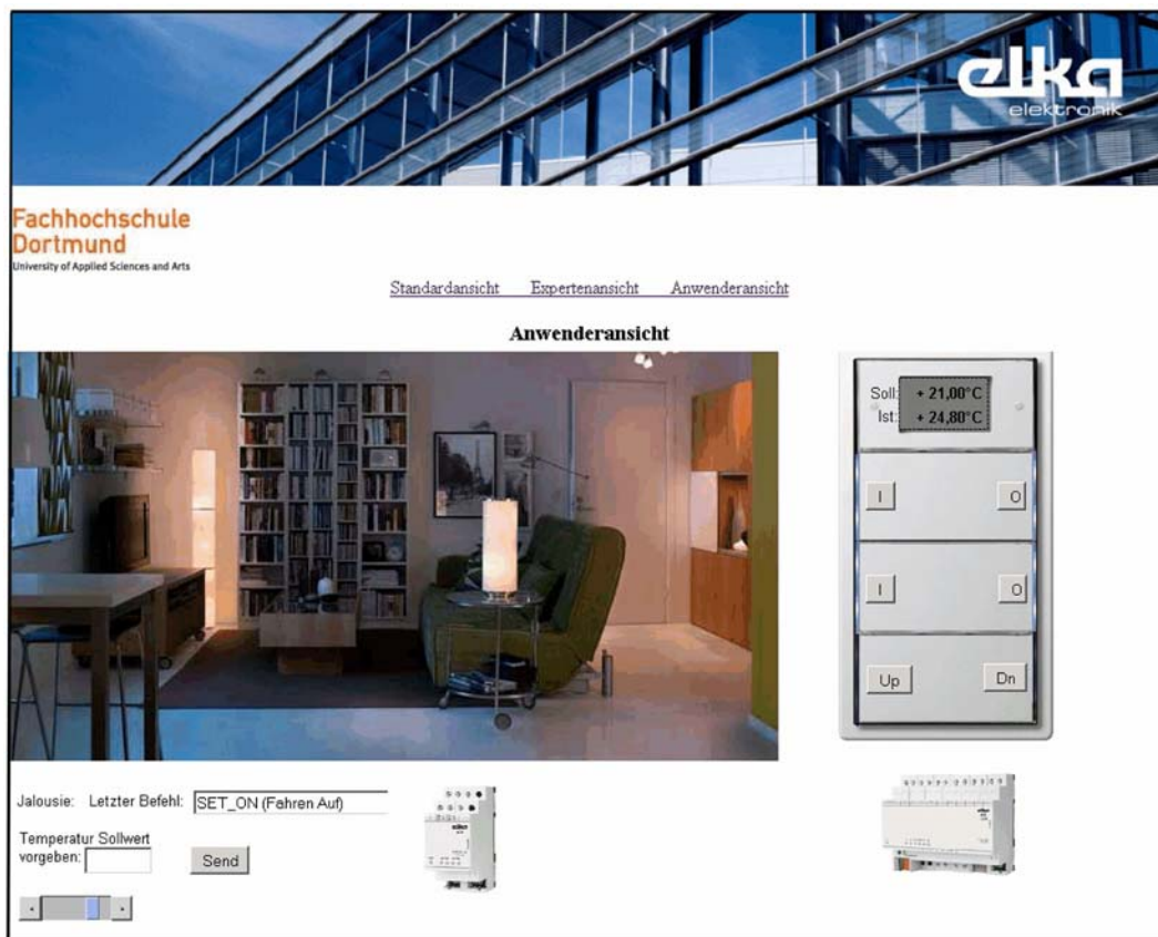
Abb. 2.68 Die Web-Seite als Bedienoberfläche. Hier ein Anwendungsbeispiel aus der Gebäudeautomation (elka Elektronik, FH Dortmund).
