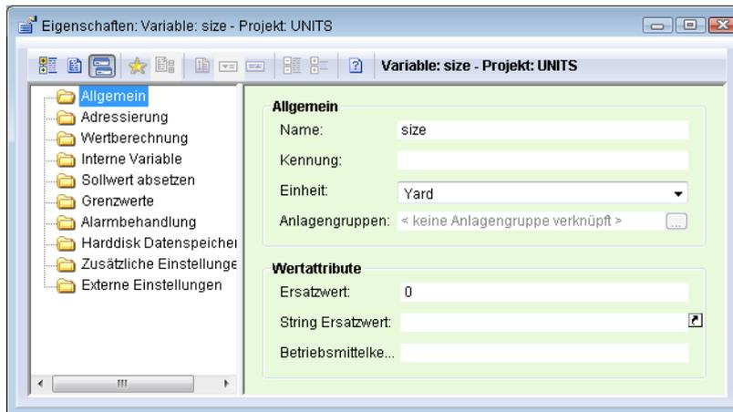
Sie können hier freie Bezeichnungen für Maßeinheiten vergeben. Soll die Maßeinheitenumrechnung zur Runtime genutzt werden, wählen Sie eine zuvor definierte Basisinheit aus der Dropdownliste aus.
