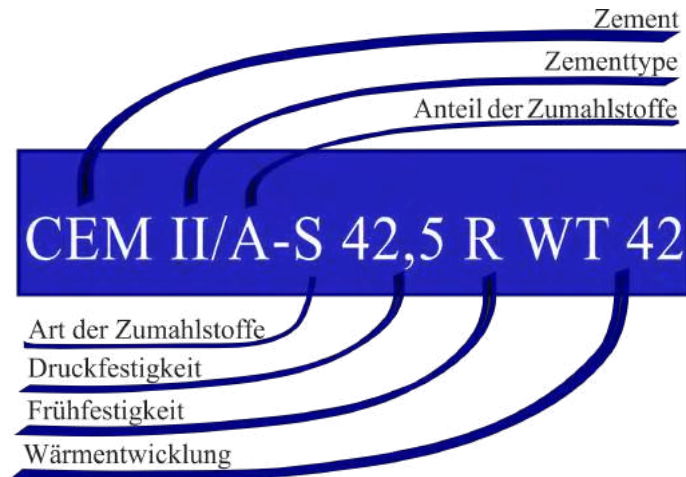
Abbildung 3.16: Kennzeichnung des Bindemittels [19]
