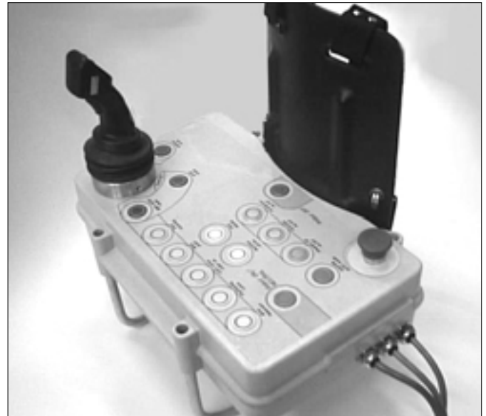
Bild 6. Fernsteuerung Fig. 6. Remote control with 6-D-joystick
