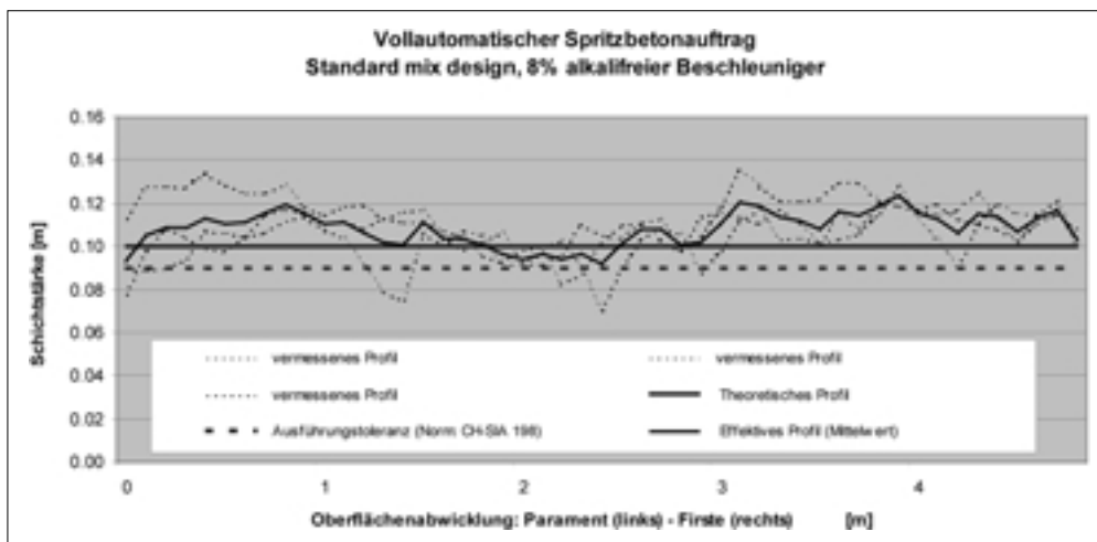
Bild 23. Schichtstärkenkontrolle bei einem Baustellenversuch Fig. 23. Layer control of fully automated shotcrete application
