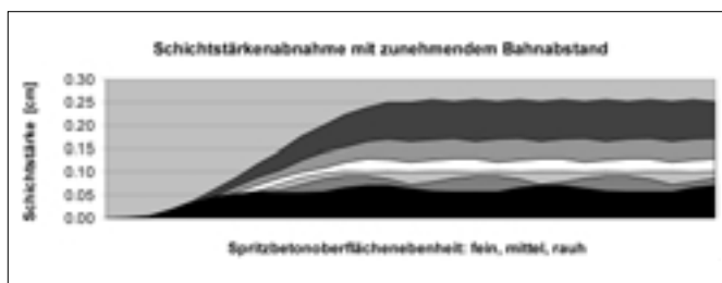
Bild 16. Ebenheit verschiedener Schichtstärken Fig. 16. Evenness of different layer thickness
