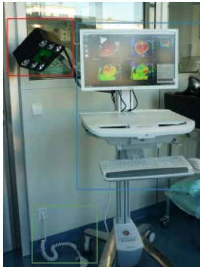
Abbildung 1: Verwendetes HSI-System von der Firma Diaspective Vision GmbH (Am Salzhaff, Deutschland) zur Aufnahme während chirurgischer Eingriffe mit einer Standfläche von ca. 0,25 m 2 ohne Schwenkarm (rot: Beleuchtungseinheit mit Objektiv und Spektalkamerasystem an Schwenkarm, blau: Softwareeinheit mit Stativ, grün: Stromversorgung),
