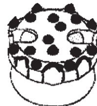
Dreikonus- Rollenzahnmeißel für mittelharte Formationen mit mittellangen Zähnen drehend (für Wasserspülung)
