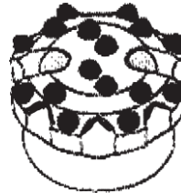
Dreikonus- Rollenzahnmeißel für weiche Formationen mit langen Zähnen drehend (für Wasser- und Luftspülung)
