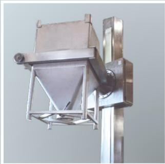
→ Container werden manuell oder hydraulisch in die Mischvorrichtung eingespannt
