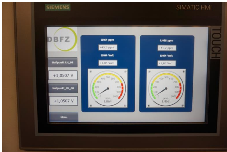
Abbildung 12: Visualisierung der Sensordaten an der SPS im Technikum am DBFZ mittels HMI-Panels
