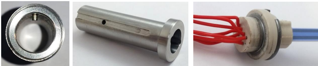
Abbildung 73: Modulares Gehäusekonzept mit Einschweiß-Stutzen für einen Schornstein (links), wechselbarer Schutzkappe (Mitte) und Klemmkontaktierung für das Sensorelement (rechts)
