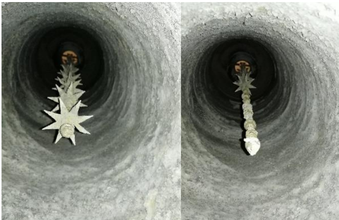
Abbildung 48: Sprühelektrode im Original mit neun und reduziert auf vier Sternelektroden
