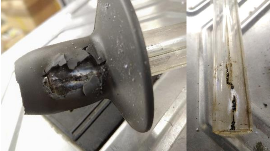
Abbildung 43: Schäden durch Kriechströme am Isolator des ESP
