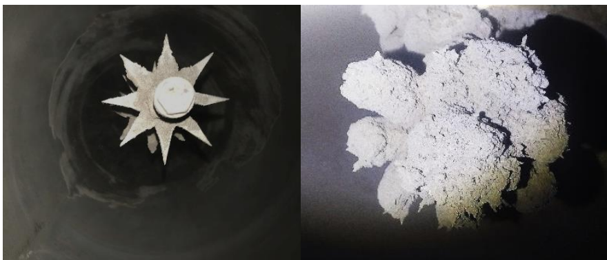
Abbildung 45: Stern-Elektroden vor und nach dem Härtetest
