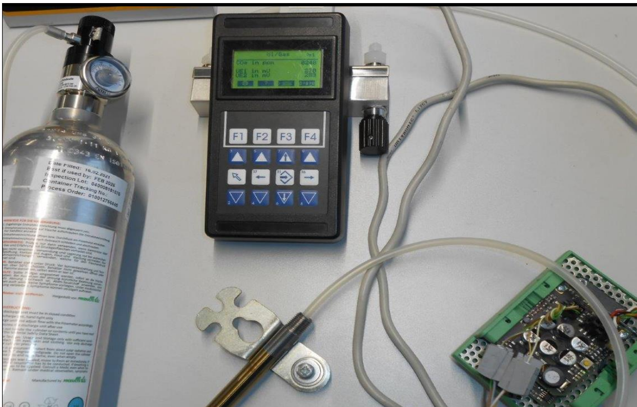
Abbildung 70: Aufbau zum Funktionsnachweis des Sensorelements mit neuer Sensordurchführung nach Integration ins Gehäuse (Hier verlängertes Gehäusekonzept)
