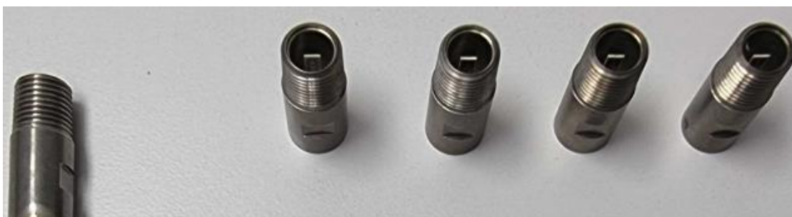
Abbildung 68: Erstmuster von Sensor-Durchführungen
