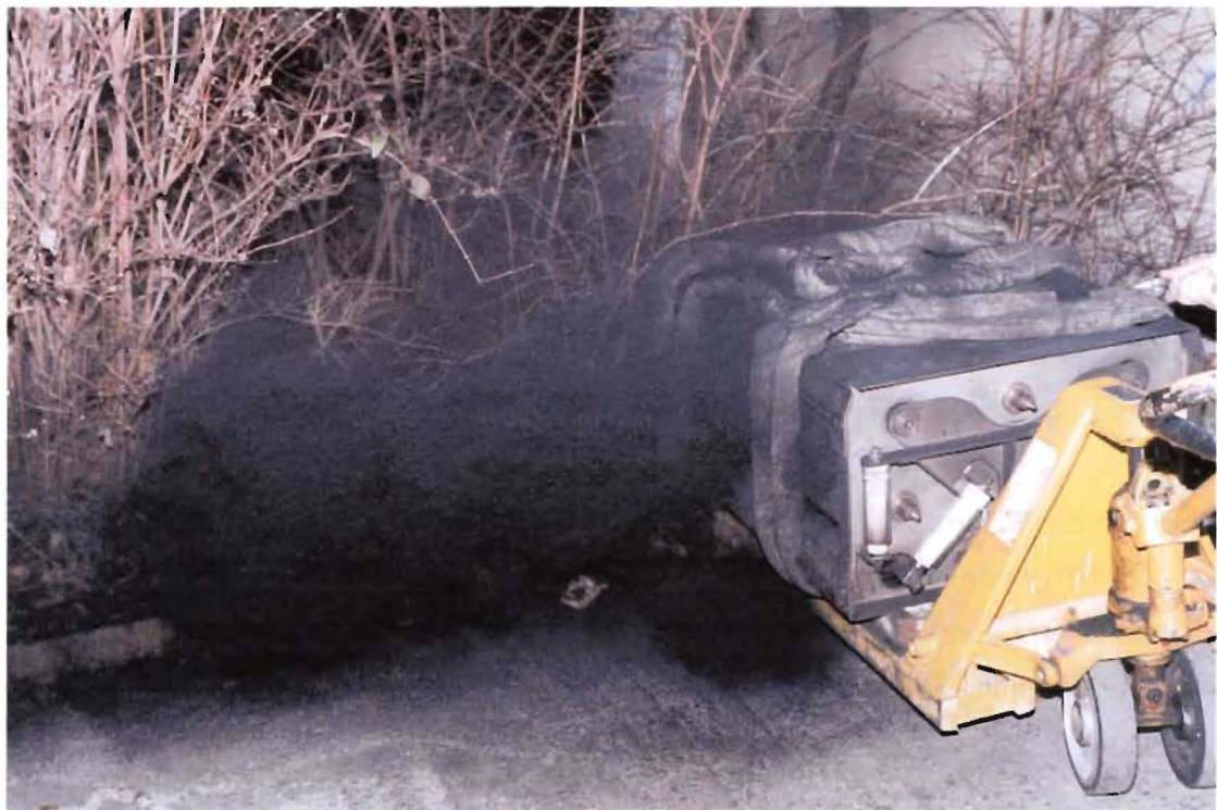
Abb. 3.16: Manuelle Reinigung des Filters mit Druckluft
