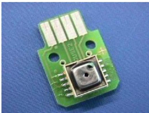
Abb. 20: entwickelte Schaltung mit Druckelement für den Drucksensor
