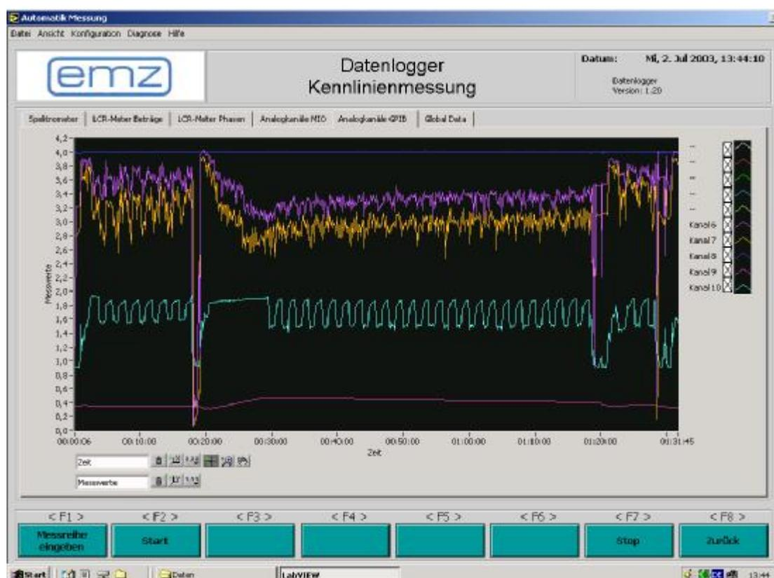
Abb. 9: Beispiel der Signalerfassung und -auswertung mit der im Projekt entwickelten Messsoftware (Verlauf der Trübungs- und Drucksignale)
