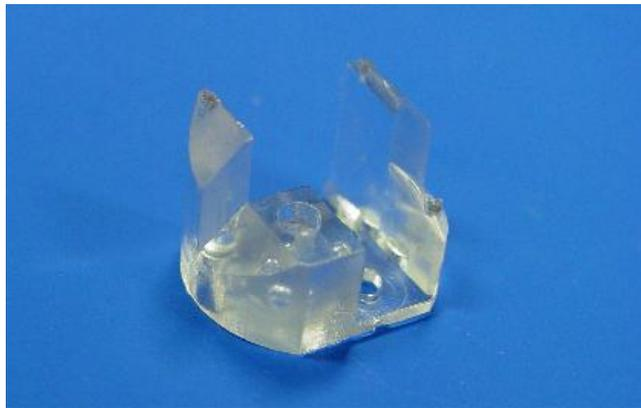
Abb. 5: Muster des neu entwickelten Sensorkopfes mit zwei Messstrecken
