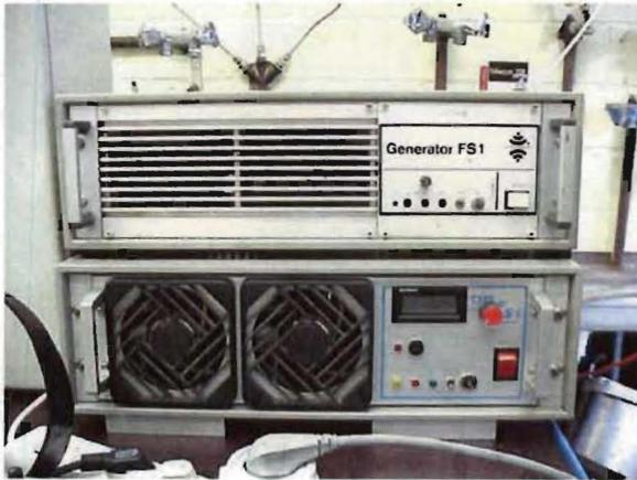
Generatoren für Ultraschalleinheiten
