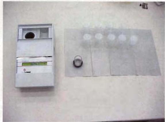
Trübungsmessgerät mit Küvette und Probenbehältern
