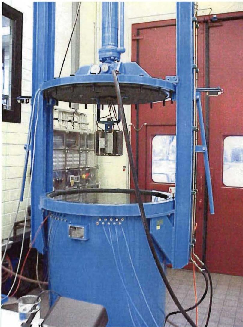
fertige Anlage URSEL bei geöffnetem Deckel, in der Mitte der Ultraschallgeber
