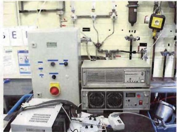
Generatoren für Ultraschalleinheiten und Hydrauliksteuerung
