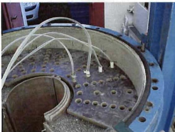
Abb. 3-4: Blick in die Versuchsanlage mit Brett zur Positionierung der Hydrophone.
