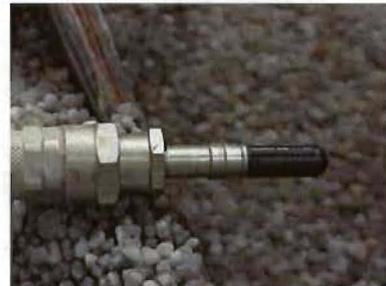
Abb. 3-3: Nahaufnahme eines piezoelektrischen Hydrophons.
