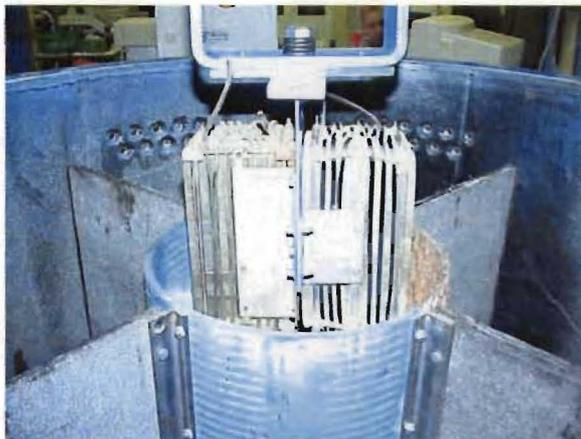
Ultraschallgeber (hinten Öffnungen für Probenahme Trübungsmessung)
