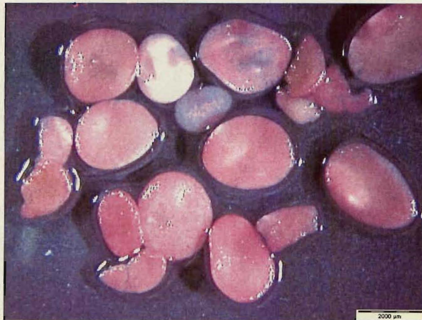
Abbildung 15: Zerstörte Linsen aus dem Prallstrahlreaktor
