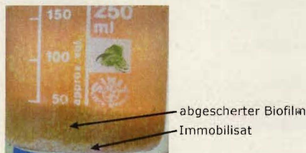
Abbildung 27: Aufnahme eines Laboransatzes nach Scherbeanspruchung mittels eines Magnetrührers
