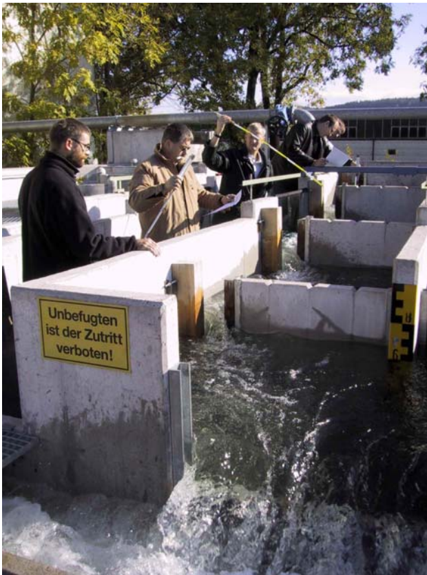
Foto 4 Praxisseminar, Messungen am Schlitzpass der Demonstrationsanlage des Hydrolabor Schleusingen
