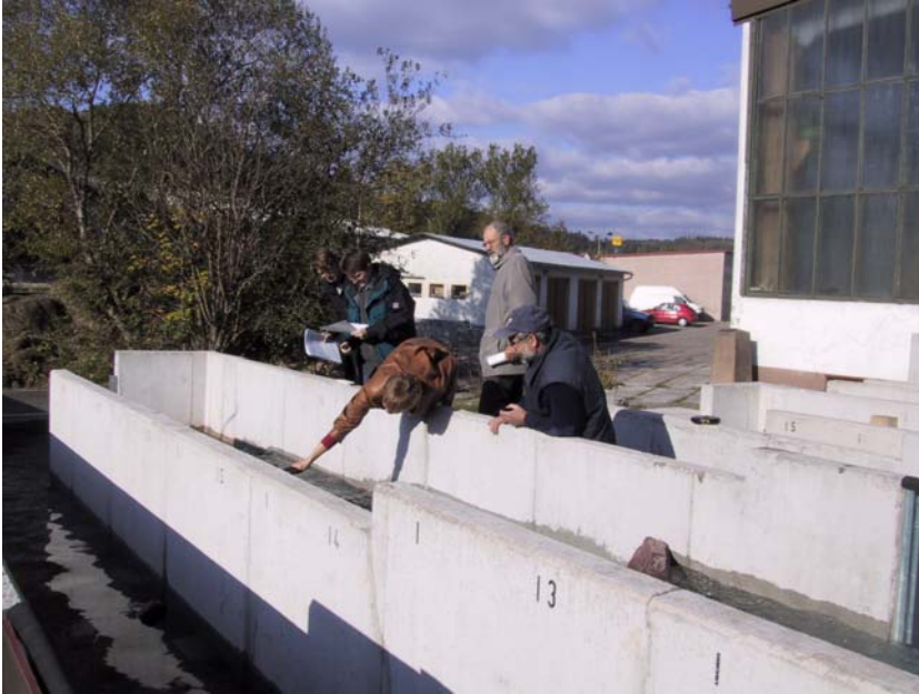
Foto 5 Praxisseminar, Messungen am Rauherinne-Beckenpass der Demonstrationsanlage des Hydrolabor Schleusingen
