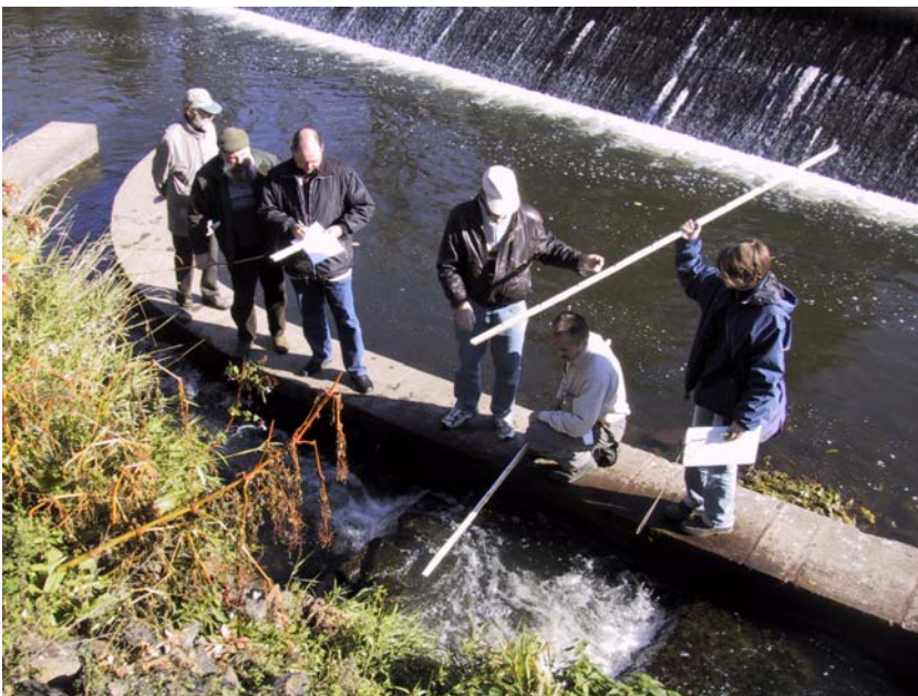
Foto 10 Vermessung des Rauhgerinne-Beckenpasses am Henneberger Wehr in Meinigen durch die Workshopteilnehmer
