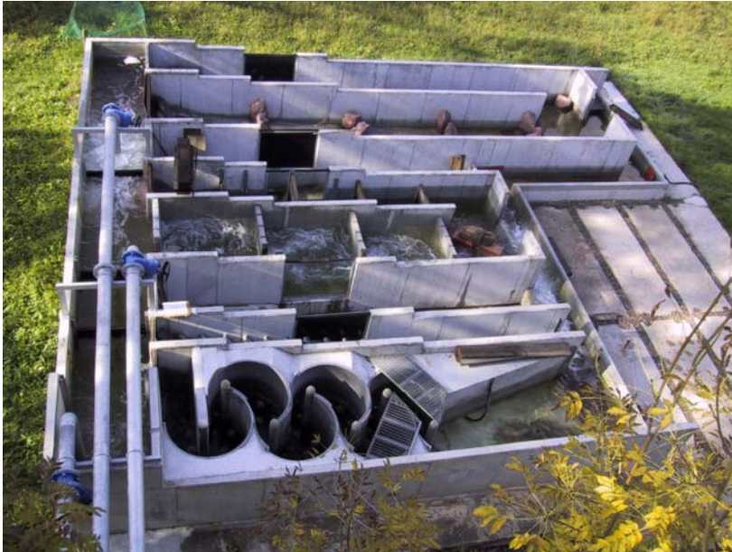
Foto 1 Demonstrationsanlage des Hydrolabor Schleusingen mit sechs 1:1 Modellen verschiedener Typen von Fischwanderhilfen
