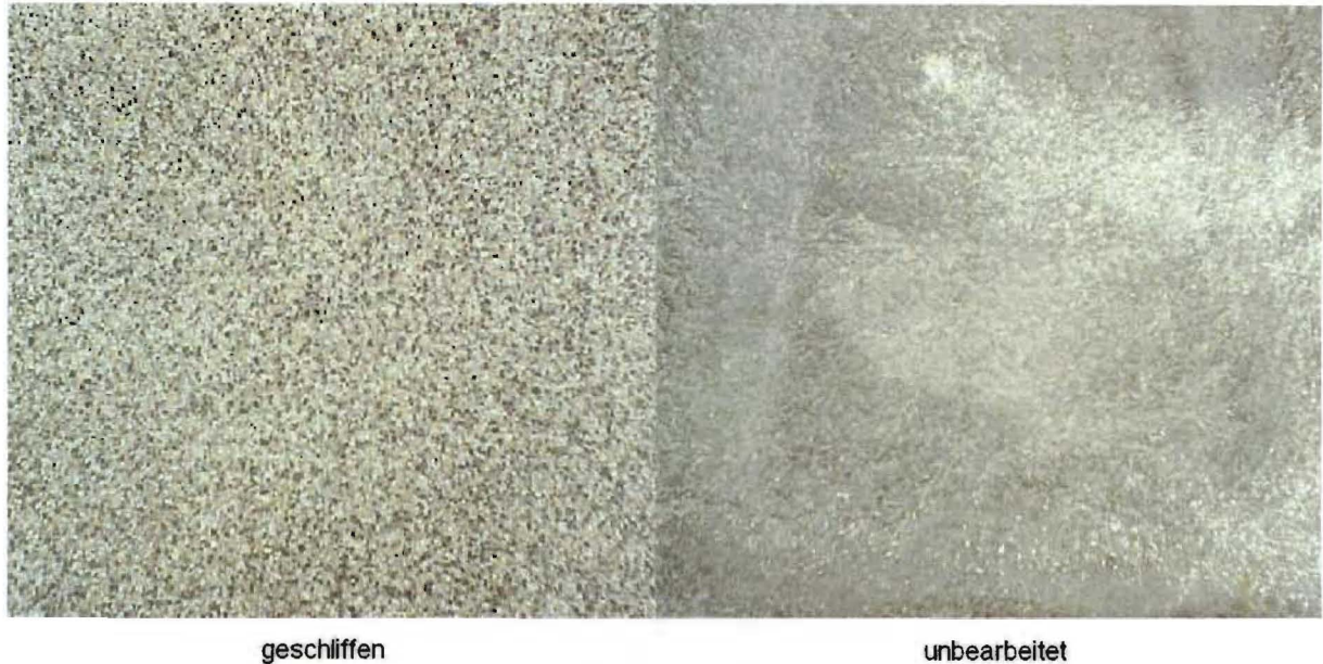
Abbildung 12: Vergleich geschliffene und unbearbeitete Terrassenplatte
