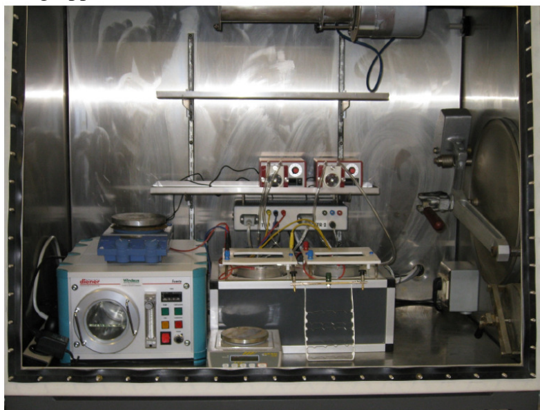
Abb.3 : Blick in die Handschuhbox mit Gestellbeschichtungsapparatur (rechts) und Plasmagenerator (links) an der TU Clausthal
