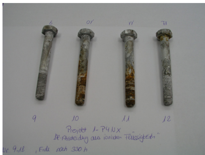
Abb.11: Bilder von aluminiumbeschichteten Schrauben nach 330h Salzsprühtest
