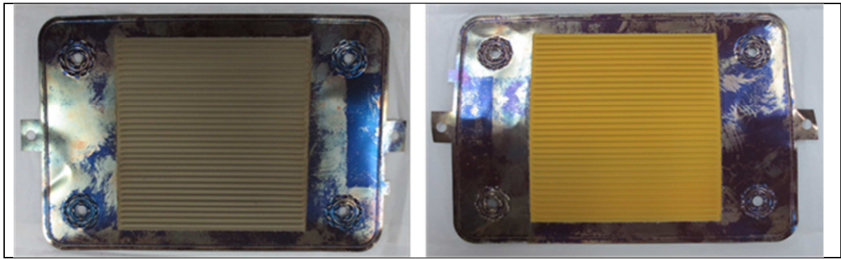
Abbildung 3-7 Beschichtung der Reformbleche mit Brennerkatalysator (links) und Reformkatalysator (rechts)
