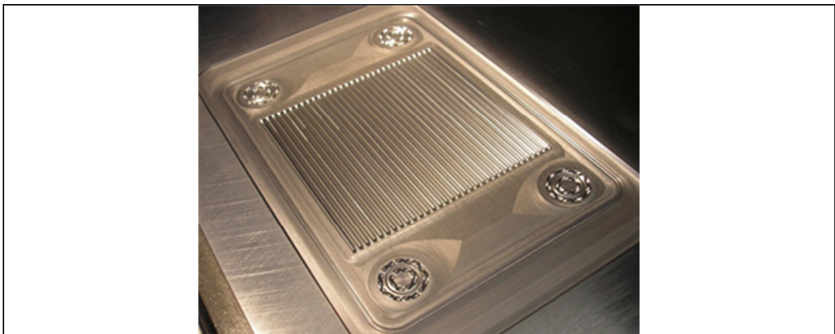
Abbildung 3-6 Werkzeug zur Fertigung der Reformerbleche mittels Hydroforming
