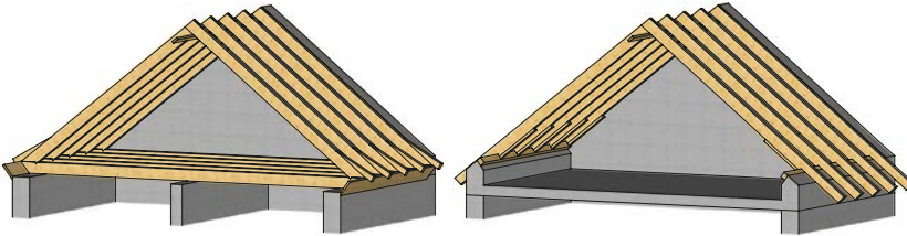
Abb. 5.12: Sparrendach auf Holzbalkendecke oder Betondecke mit Drempel
