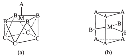
Abb. 20.15 Überkappt-quadratisch-antiprismatische (a) sowie dreifach überkappt-trigonal-prismatische (b) Metallkoordination.
