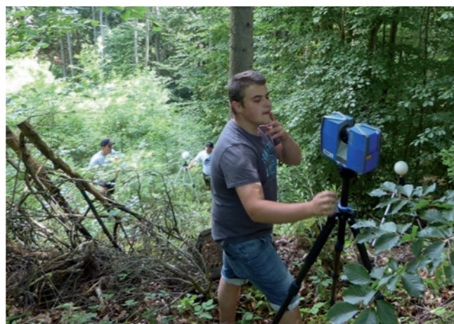
Im Zuge einer Diplomarbeit nehmen Schüler einen Bestand im Lehrforst Bruck mit einem stationären Laserscanner auf.
