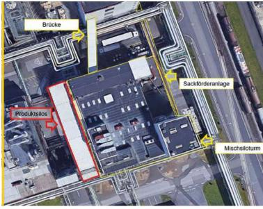
Abbildung 5: Abzubrechendes Produktionsgebäude (gelb) und zu erhaltende Produktsilos (rot) | Fotos: ERM
