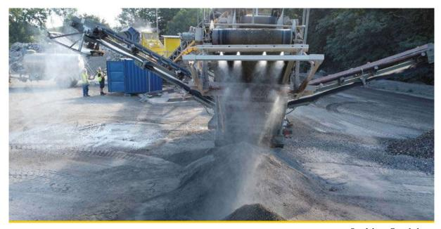
Bandabwurfbenebelung: In das vom Band fallende Material wird Wassernebel eingebracht, so werden Staubaufwirbelungen vermieden und es kommt zu einer geringeren Staubentwicklung. Der Wassereintrag ist durch Düsenanzahl, Düsengröße und Wasserzufuhr sehr effizient steuerbar.
