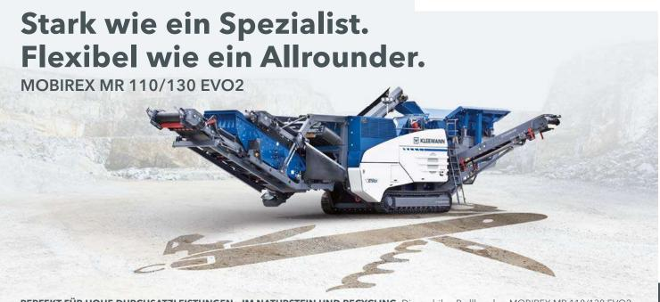
**PERFEKT FÜR HOHE DURCHSATZLEISTUNGEN - IM NATURSTEIN UND RECYCLING.** Die mobilen Prallbrecher MOBIREX MR 110/130 EVO2 verfügen über ein ausgeklügeltes Materialflusskonzept und einen kraftvollen Diesel-Direkt-Antrieb - für hohen Durchsatz bei optimiertem Verschleiß und Verbrauch. Dank ihrer kompakten Bauform sind die Anlagen dabei gut transportierbar und ebenso schnell auf- wie wieder abgebaut. Die MR 110/130 EVO2 - vielseitig und voller Power.
