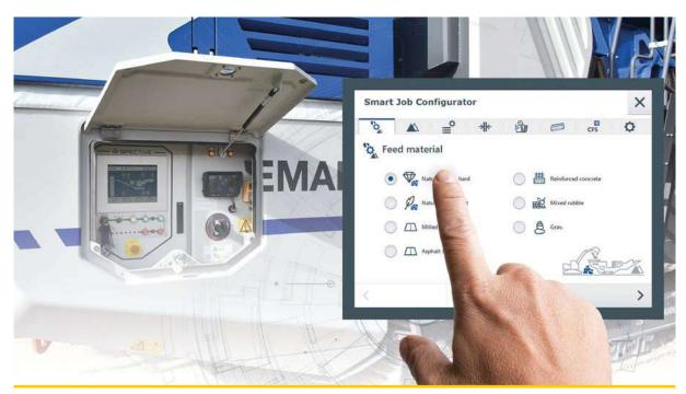
Am SPECTIVE Touchpanel lässt sich der Smart Job Configurator als "Quickstart" für ein schnelles Einrichten der Kleemann Maschine nutzen.
