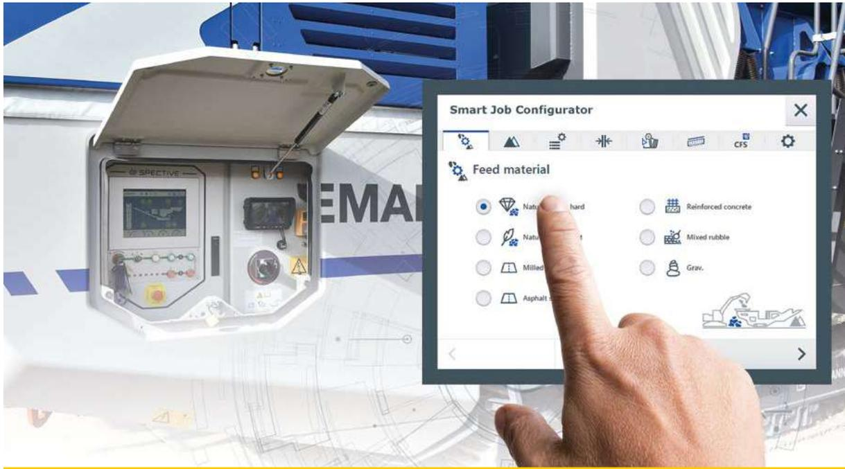
Am SPECTIVE Touchpanel lässt sich der Smart Job Configurator als „Quickstart“ für ein schnelles Einrichten der Kleemann Maschine nutzen.
