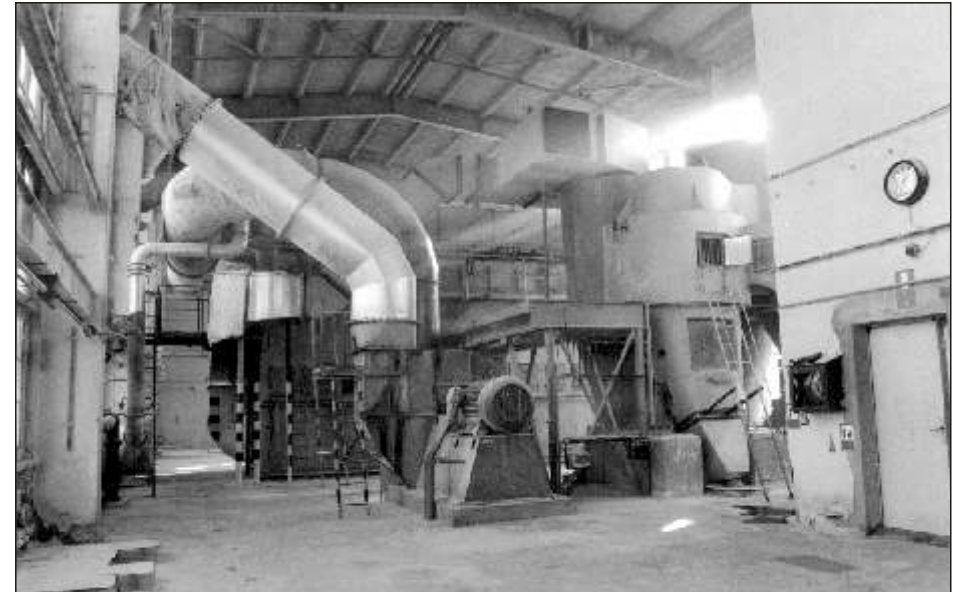
Bild 16 ABS-Anlage E 74 - Zweistufiger Stromtrockner
