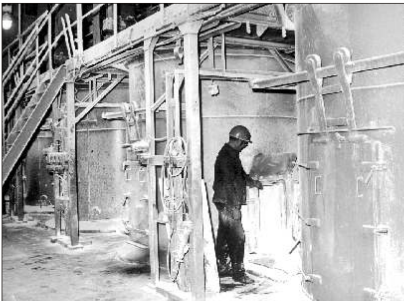
Bild 8 Nutschen zur Trennung von Perlpolymerisat und Mutterlauge in E 92
