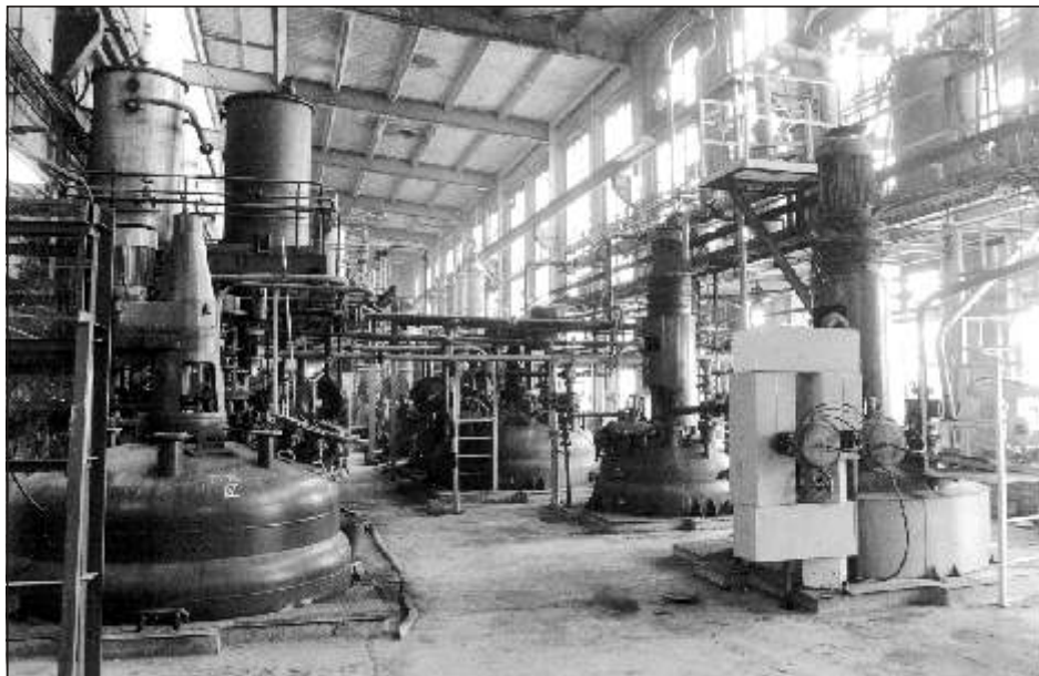
Bild 15 ABS-Anlage E 74 - Blick auf die Pm-Kessel und die kontinuierliche Latexfällung für ABS
