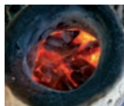
Mit Holzkohle vermischt wird Eisenerz in Rennöfen zu schmiedbarem Eisen reduziert. Übrig bleiben Schlacke und die schwammförmige »Luppe«. Per Hand müssen Kohlenstoff und andere Einschlüsse herausgeschmiedet werden.
