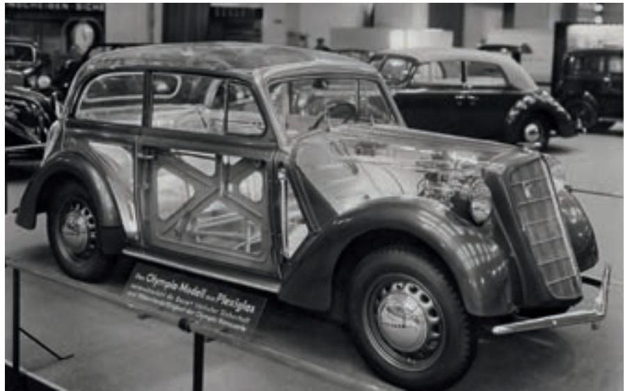
Opel produzierte ab 1935 den Olympia mit einer aus Blechträgern und Profilen bestehenden selbsttragenden Ganzstahlkarosserie, bei der auch Säulen und Dach Kräfte übertragen.
