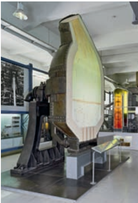
Der Halbschnitt einer Bessemerbirne, ein Geschenk der Firma Krupp, befindet sich seit den ersten provisorischen Ausstellungen zum Thema Eisenerzeugung und Stahl im Jahre 1909 im Deutschen Museum.
