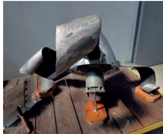
Verformung bei voller Leistung: die Überreste von Rotorenblättern.
