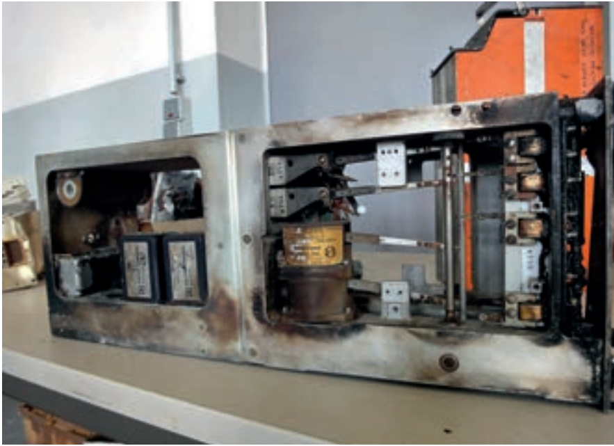
Die Überreste eines der ersten Flugschreiber. Vier Nadeln drückten Kurven in eine dünne Metallfolie.
