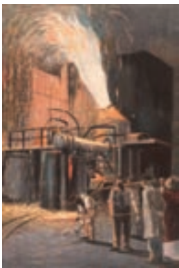
Henry Bessemer erfindet 1856 ein feuerfestes Gefäß, in dem aus Roheisen Stahl erzeugt werden kann. In der »Bessemerbirne« wird Luft von unten durch das flüssige Eisen gepresst.
