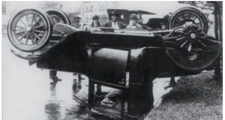
Dodge Coupé um 1916 mit Budd-Ganzstahlkarosserie, die hier einen unfreiwilligen Beweis ihrer Überschlagesicherheit liefert. Damals genügten Bordsteine, um die Holzspeichenräder wegbrechen zu lassen und das Auto aufs Kreuz zu legen. Bei einem Holzaufbau wären die Insassen vermutlich zerquetscht worden.
