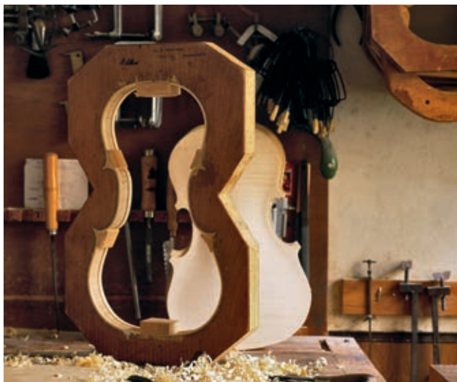
Die Spitzschablone für den Zargenkranz bestimmt den Umriss der Geigendecke.
