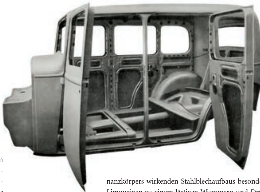
Blick in eine Ambi-Budd-Ganzstahlkarosserie für vermutlich Adler Primus 1934/35, bestehend aus Bodenblech mit Kardantunnel und Querversteifungen, Spritzwand mit Windschutzscheibenrahmen, Dach mit Heckwand und gegenläufig öffnenden Türen mit Schlosssäule. Separates Fahrgestell noch erforderlich.
