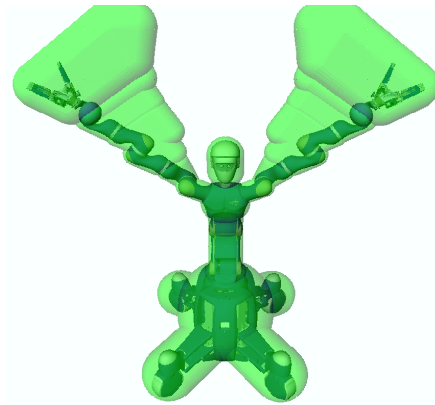
Abbildung 6: Beispiel für dreidimensional Schutzfelder. Roboter Justin des DLR beim „Zusammenklatschen“ der Hände. Die berechneten Schutzfelder sind grün überlagert.
