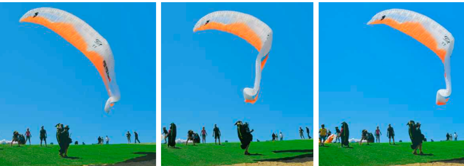
Beispiel für einen Klapper durch Entlaster, hier beim Start. Komplettes Unterschneiden der im Flug stabilen Flächen, die dann massiv verhängen können
