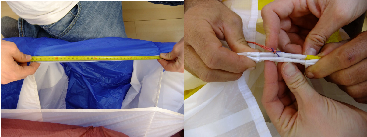
5. Abmessungen der mittleren Eintrittsöffnungen im Vergleich Seriengerät zu eingelagertem Mustergerät.
