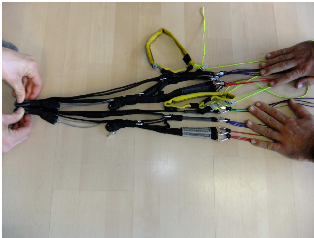
2. Konstruktion der Tragegurte und die Länge des Beschleunigerweges im Vergleich Seriengerät zu eingelagertem Mustergerät.
