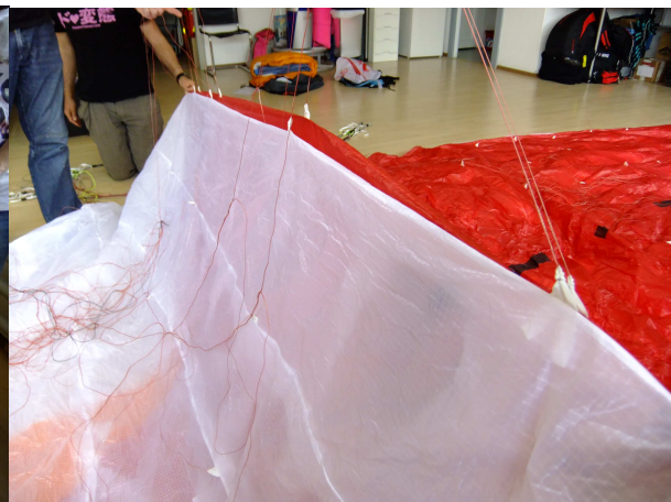
4. Leinenansatzpunkte an den mittleren Zellen im Vergleich Seriengerät zu eingelagertem Mustergerät.
