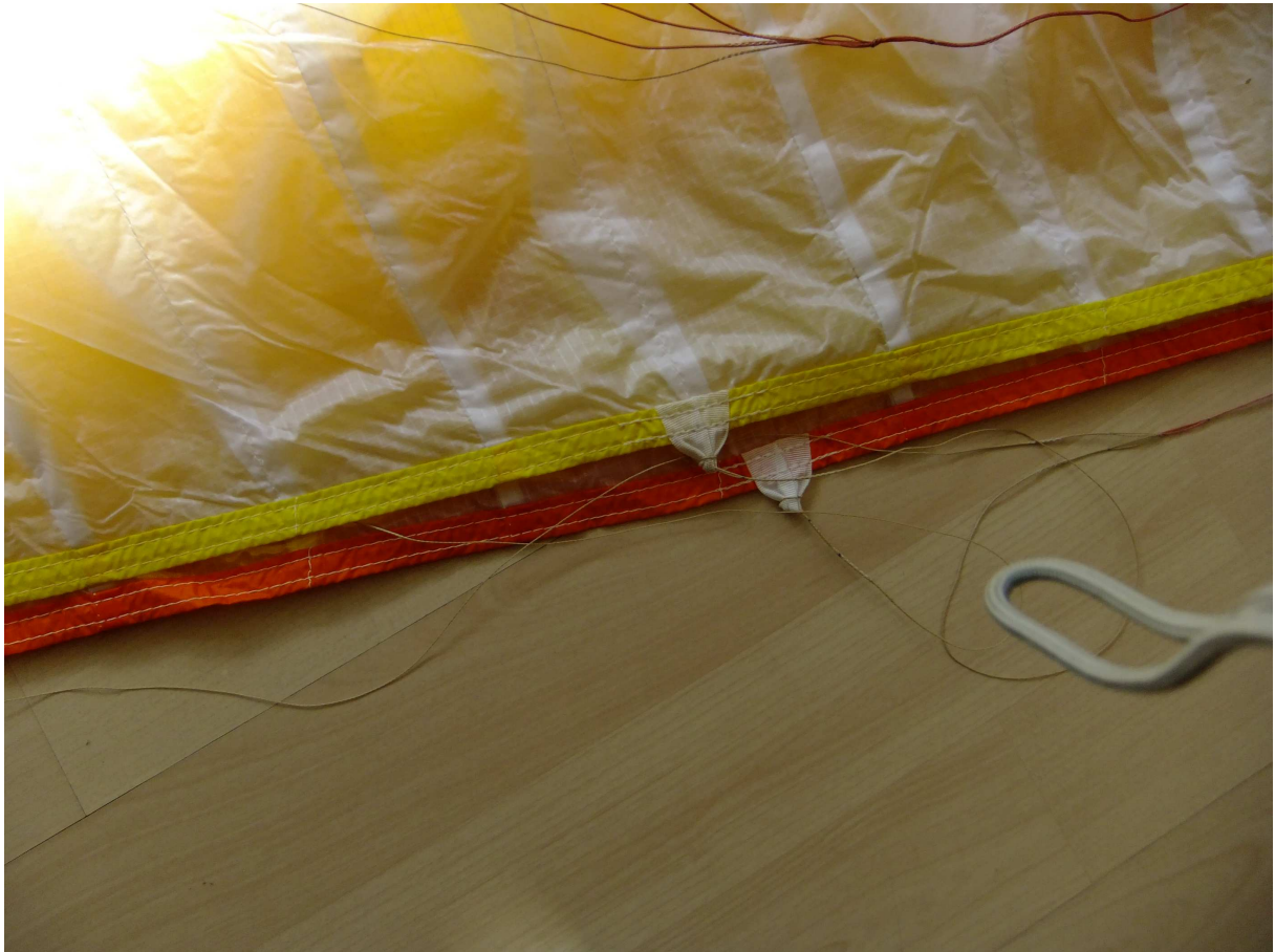
7. Bremsleinenanlenkungen im Vergleich Seriengerät zu eingelagertem Mustergerät
