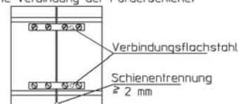
Detail A (mechanische Verbindung der Förderschiene)
