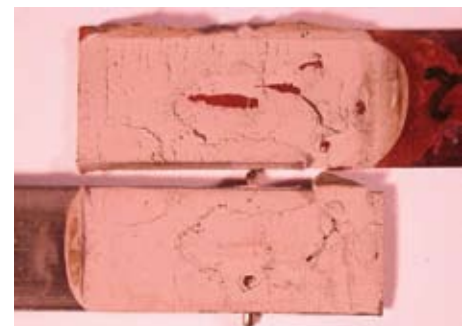
Bild 9 Bruchbilder mit Klebstoff PU1/P1 nach Wechselklima
