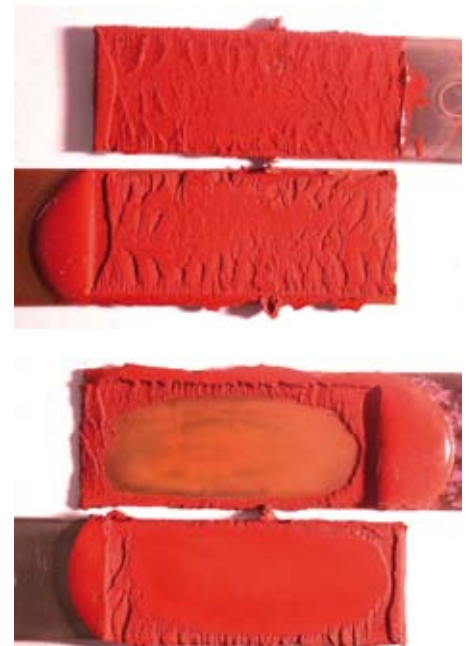
Bild 8 Bruchbilder mit Siliconklebstoff nach Lagerung Normal- (oben)/Wechselklima (unten)
