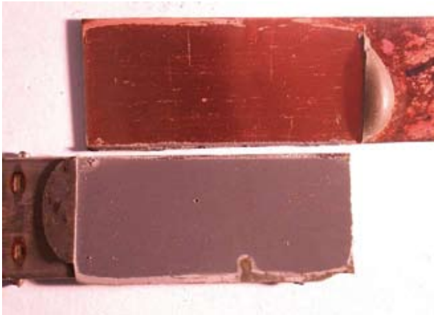
Bild 10 Bruchbilder mit Klebstoff EP nach Wechselklima
