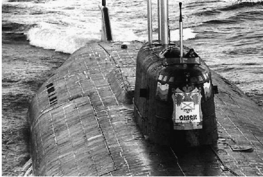
Bild 2.12: Der Rumpf der russischen Atomunterseeboote der OSCAR II Klasse ist aus einer Titanlegierung gefertigt. Auch die im August 2000 vor Murmansk gesunkene 18.000 Tonnen schwere und 155 Meter lange Kursk gehörte dieser Klasse an.
