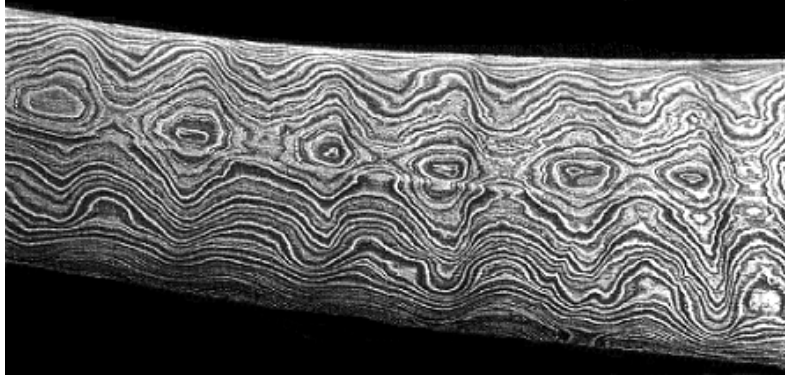
Bild 1.5: Angeätzte Mikrostruktur in einem Schmiedestück aus Damaststahl.
