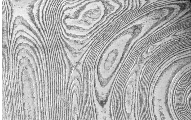
Bild 9.8: Durch Ätzung sichtbar gemachtes Muster eines Damaststahls.
