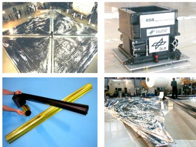
BILD 1: ESA-DLR Solar Sail Technologieträger 1999/2000. Sub-Systeme Entfaltungsmodule, entfaltbare Masten und Segel.
