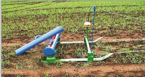
Abbildung 2: Messschlitten für das EM 38.
