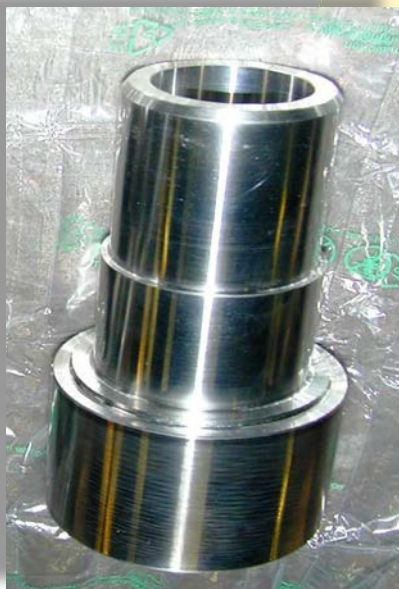
Plasma - Ionitrierte Hülsen Grundwerkstoff 1.4571
