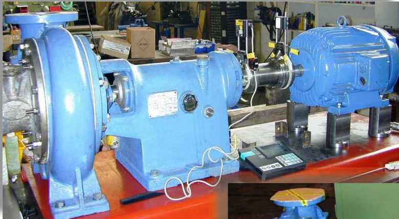
Generalüberholung mit Laser ausrichten
