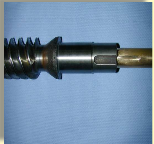
Ersatzteile Spindelhubgetriebe Beispiel Schneckenwelle Voith
