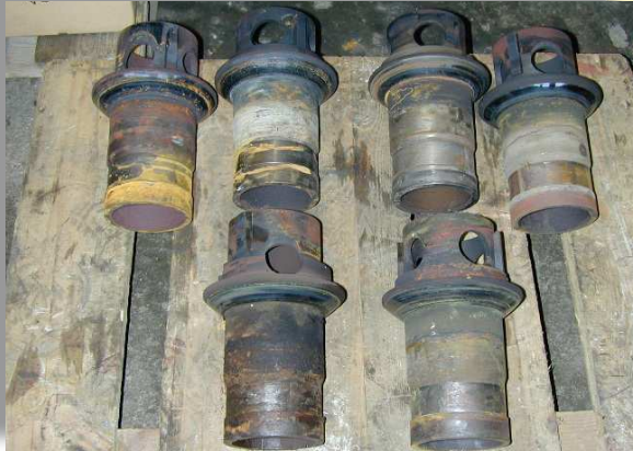
Ersatzteile Dampfkopf Beispiel Q-Nippel Johnson
