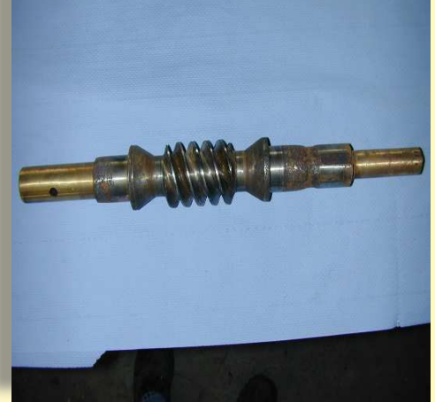
Ersatzteile Spindelhubgetriebe Beispiel Schneckenwelle Voith
