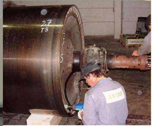
ausgebaute Trockenzylinder mit Austausch Zylinderdeckel
