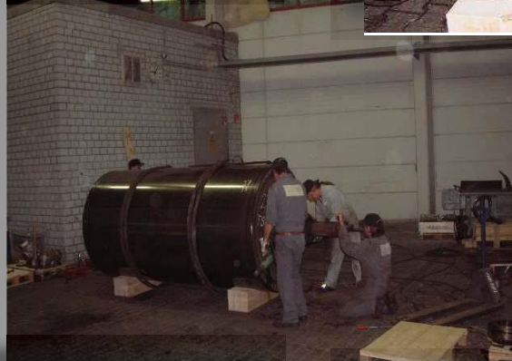
ausgebaute Trockenzylinder mit Austausch Zylinderdeckel
