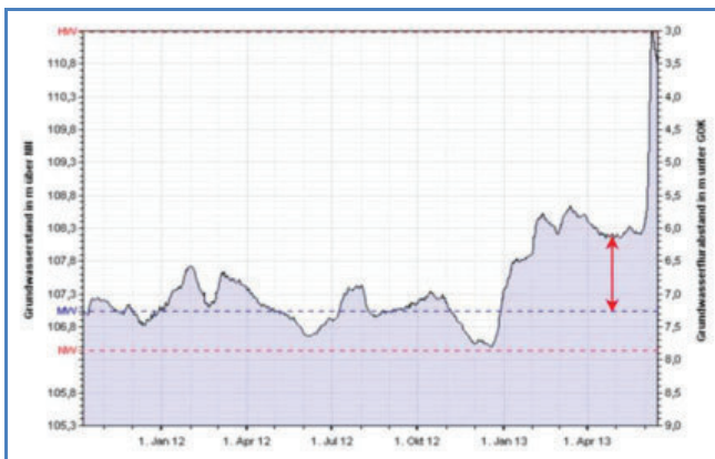
Abb. 7.1.1.1: Grundwasserstandsganglinie der Messstelle 5892, Salbachstraße
