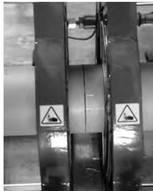
Das Schweissgerät fährt die Rohre oder Rohr und Fitting zusammen. Die Abkühlzeit beginnt.
