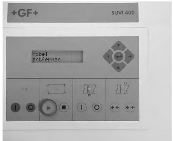
Auf dem Display erscheint: Hobel entfernen. Der Hobelvorgang ist beendet und der Hobel schaltet automatisch ab. Wenn der Hobel abgeschaltet ist, nehmen Sie ihn aus der Schweissvorrichtung und stellen ihn zurück in die dafür vorgesehene Haltevorrichtung.
