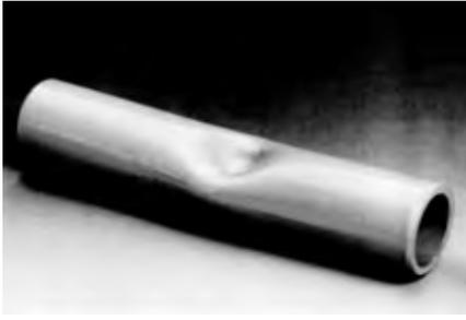
**Duktiler Bruchverhalten** liegt dann vor, wenn bei gewaltsamer Beschädigung einer Leitung und somit verbundener explosionsartiger Entspannung der Druckluft **keine Splitterbildung** entsteht. Somit geht keine unmittelbare Gefahr für die Umgebung aus.
