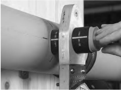
Schieben Sie den Aufscheiss-Sattel und das Rohr gleichzeitig auf die Heizbuchsen. Anwärmzeit siehe Tabelle 2.
