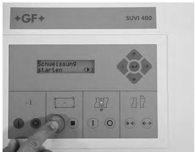
Auf dem Display erscheint: Schweißung starten. Drücken Sie die grüne Taste >bis die rote Kontrolllampe in diesem Feld leuchtet. Die beiden Rohre oder das Rohr und das Fitting fahren zusammen.
