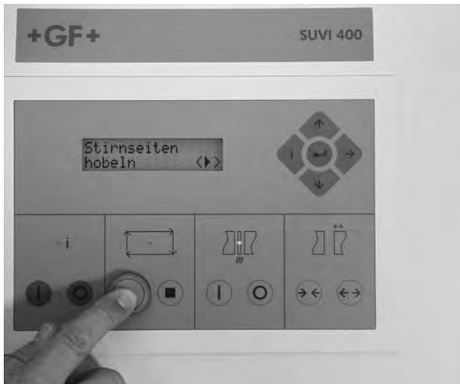
Auf dem Display blinkt abwechselnd: Hobel einlegen und Stirnseite hobeln.
