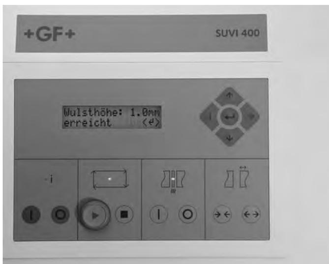
Auf dem Display erscheint: Wulsthöhe: 1.0mm erreicht. Diese Angabe muss durch den Schweisser optisch kontrolliert werden. Bestätigen Sie mit der grünen Taste Enter. Das Schweissgerät senkt den Anpressdruck auf den Schweissspiegel.
