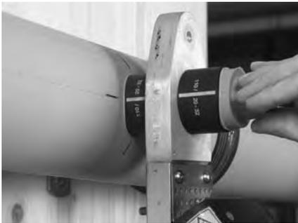
Schieben Sie den Aufscheiss-Sattel und das Rohr gleichzeitig auf die Heizbuchsen. Anwärmzeiten siehe Tabelle 1.
