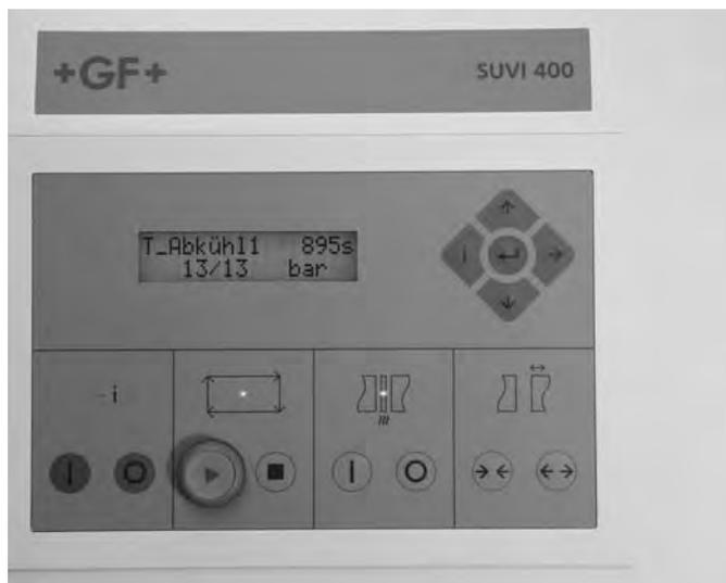
Auf dem Display wird angezeigt, wenn die Abkühlzeit beendet ist. Drücken Sie die grüne Taste Enter. Das Schweissgerät entlastet die Schweissung.
