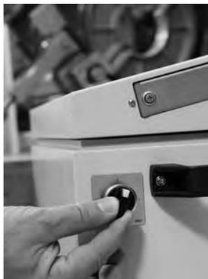
Schalten Sie die Steuereinheit Suvi 400 mit dem Geräteschalter an der rechten Geräteseite ein.
