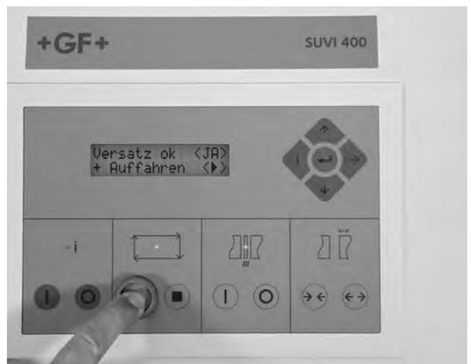
Auf dem Display erscheint: Versatz ok <JA> + Auffahren. Der Versatz zwischen den Rohren oder Rohr und Fitting ist kleiner als >1 mm. Drücken Sie die grüne Taste Enter. Ist der Versatz <1 mm zwischen den Rohrenden oder Rohr und Fitting können Sie die Rohrenden auffahren, die Rohre verdrehen, so dass der Versatz 1 mm ist.
