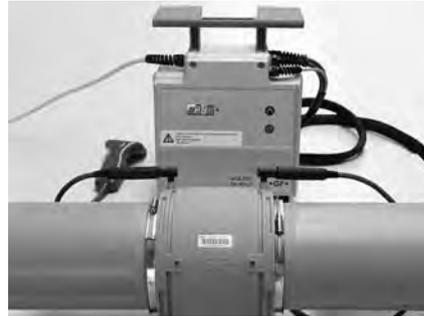
Schliessen Sie die Schweißkabel des MSA 250 Ex Multi Plus an die Elektroschweißmuffe an.
